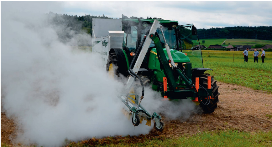
Thermische Verfahren mit Wasser als Energieträger eignen sich nicht zur selektiven Unkrautbekämpfung in Reihenkulturen. Bild: Hunger
