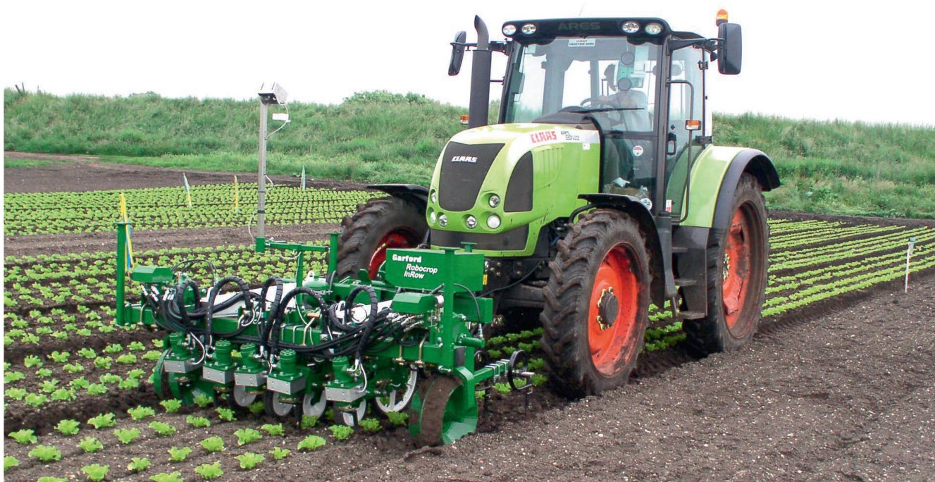
Ein System mit hohem ökologischem Nutzen ist die bildbasierte Unkrautregulierung «Robocrop» von Garford. Bild: Garford
