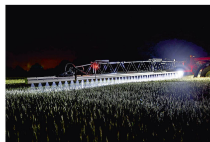
Zwei zentrale LED-Scheinwerfer machen das Spritzbild auch nachts sichtbar.
