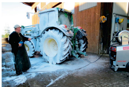
Die Schaumbecherlanze ermöglicht einen effizienten und sparsamen Einsatz von Reinigungsmitteln aller Art.
