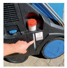
Eine einfache, aber zuverlässige Anzeige für den Dieseltank.
