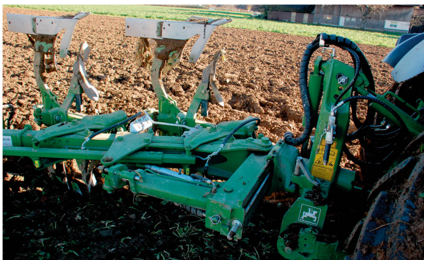
Das Einstellzentrum der stufenlosen hydraulischen Schnittbreitenverstellung. Im Bild (Mitte, leicht links) sieht man den Anzeiger, der den Fahrer über die eingestellte Schnittbreite informiert.
