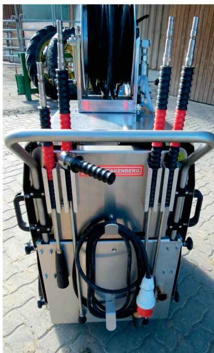
Die massive Metallhaube schützt das Gerät vor Wasser und Schmutz.
