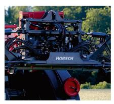
Die Gestängeführung arbeitet mit zwei Parallelogrammen.
