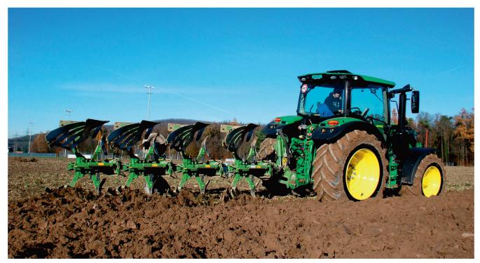
Der 4-Scharpflug «Cayros XM 4-950 VS» von Amazone ist für Traktoren bis 140 PS ausgelegt. Bilder: H. Röthlisberger
