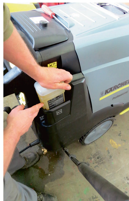
Für das Entkalken wird seitlich eine Patrone eingesteckt.
