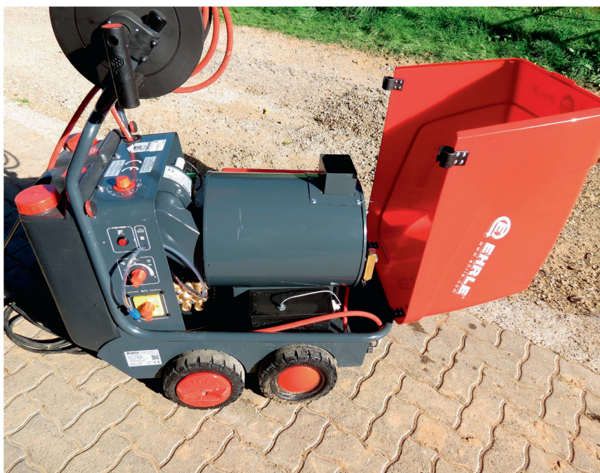
Einfach und zweckmässig: Einteilige Abdeckhaube aus Kunststoff.
