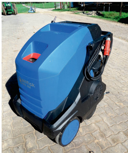
Dank Eigengewicht von 149 kg ist die Maschine gut manövrierbar.
