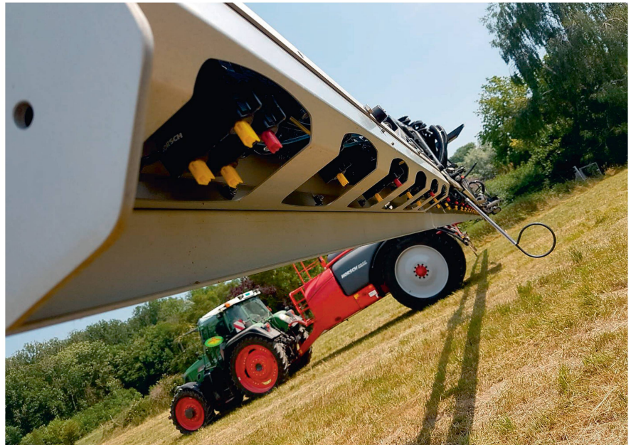
Mit Abständen von 50 und 25 cm werden zwei unterschiedliche Düsenträger eingesetzt.
