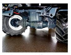
Die Achsen von Dana sind für eine Last von je 7 t (je Achse) ausgelegt. Der Lenkeinschlag beträgt 50°.
