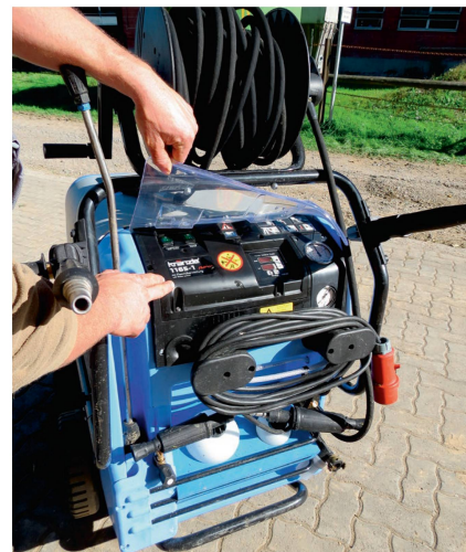
Eine transparente Auflage schützt das Armaturenbrett und die Schalter.
