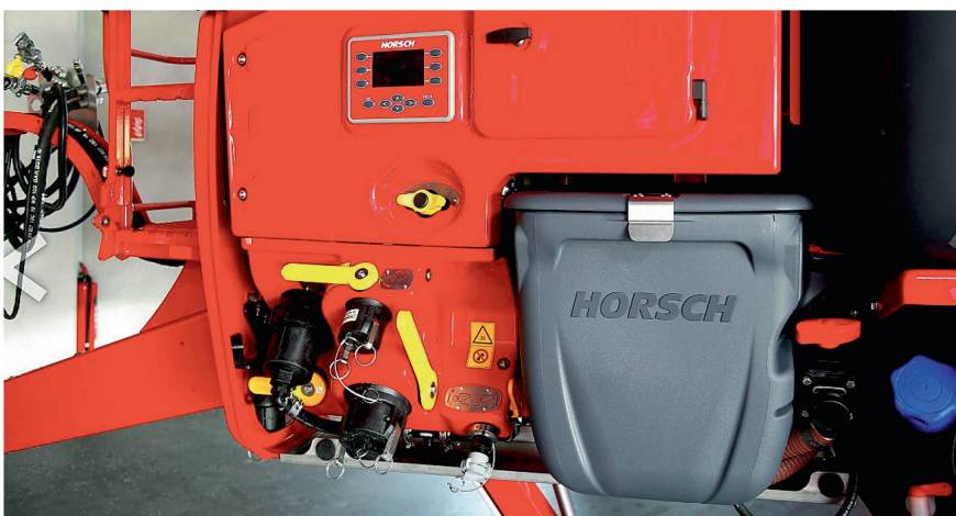
Die Bedienung zum Befüllen mit Aussenbedienterminal ist auf der linken Seite angebracht.
