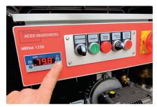
Die Temperatur kann über Folientasten eingestellt werden.
