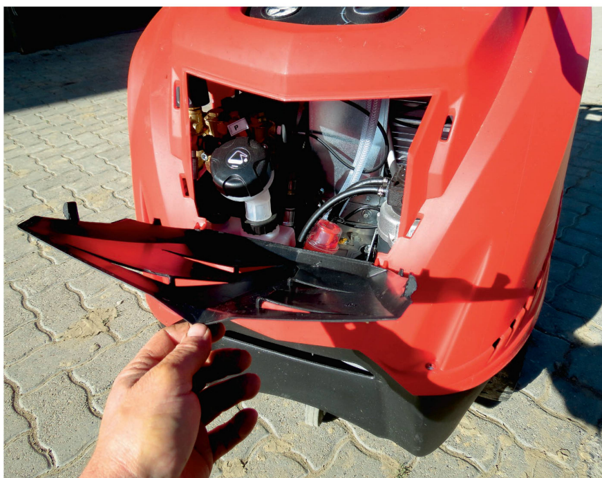
Eine einfache Klappe im Frontbereich macht den Unterhalt einfach.
