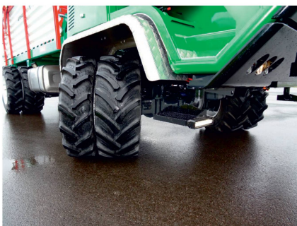
Ein Detail elegant gelöst: Am untersten Einstiegstritt ist das Tagfahrlicht angebracht.
