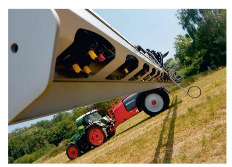
Mit Abständen von 50 und 25 cm werden zwei unterschiedliche Düsenträger eingesetzt.
