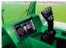
Über den Joystick werden sämtliche Fahr-, Getriebe- und Hydraulikfunktionen des Transporters gesteuert.
