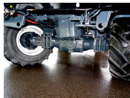
Die Achsen von Dana sind für eine Last von je 7 t (je Achse) ausgelegt. Der Lenkeinschlag beträgt 50°.
