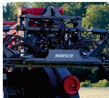
Die Gestängeführung arbeitet mit zwei Parallelogrammen.
