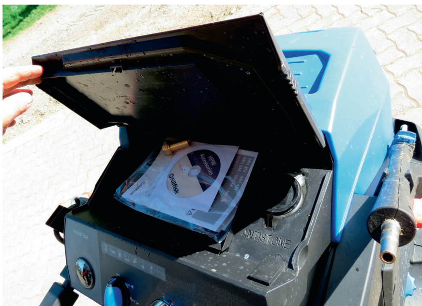
Im Ablagefach hat es Platz für Zubehör. Rechts aussen der Einfüllstutzen für Enthärter-Flüssigkeit.
