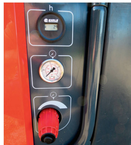
Blick auf die linke Seite mit Stundenzähler, Druckanzeige und der Druckanpassung.
