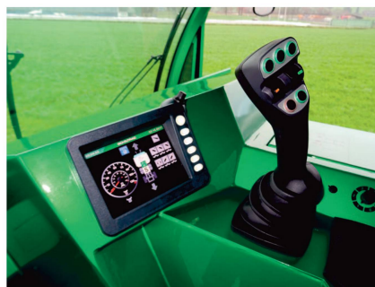
Über den Joystick werden sämtliche Fahr-, Getriebe- und Hydraulikfunktionen des Transporters gesteuert.
