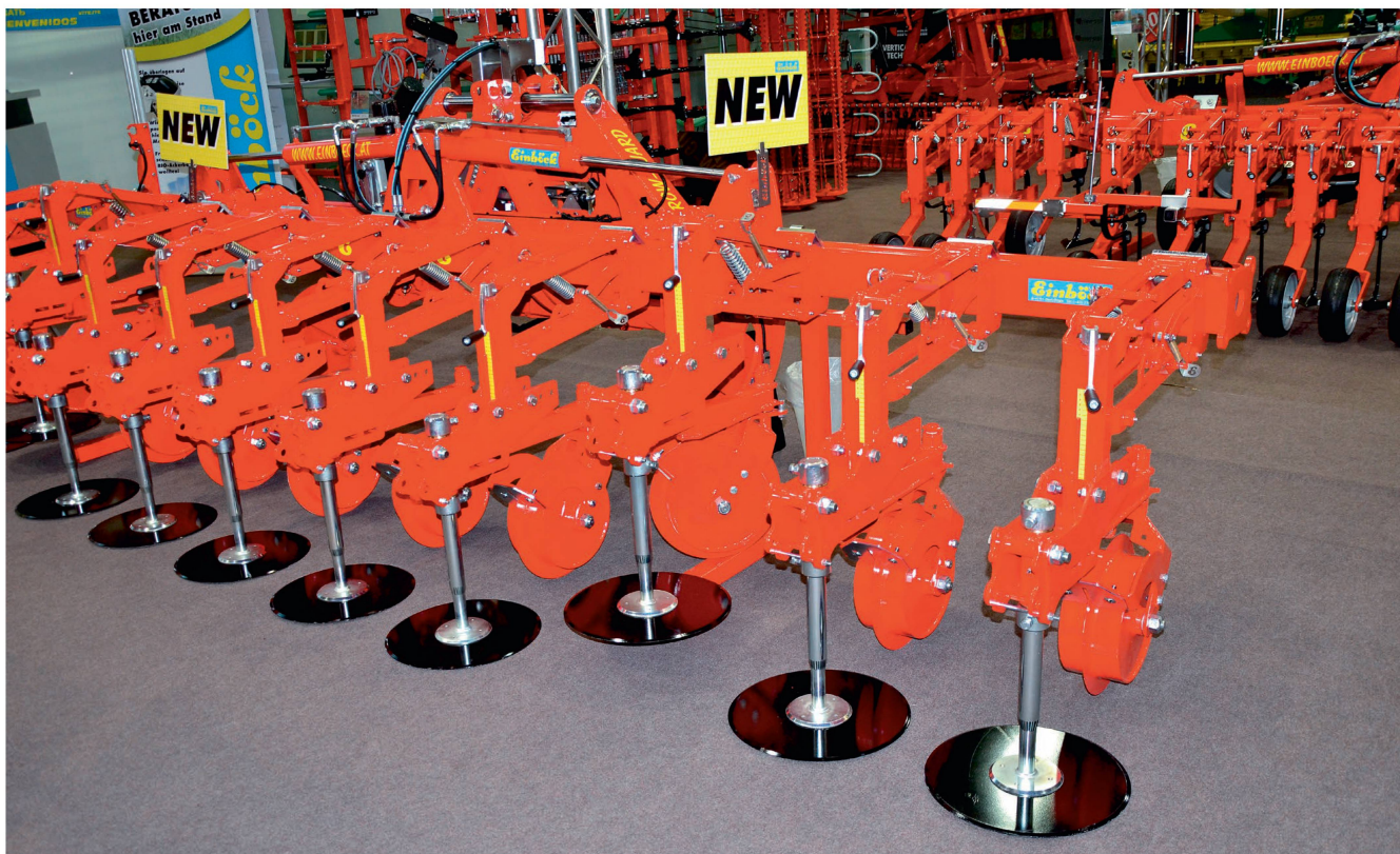
Horizontal frei drehende Schneideller sind eine Neuheit auf dem Markt. Bild: R. Hunger
