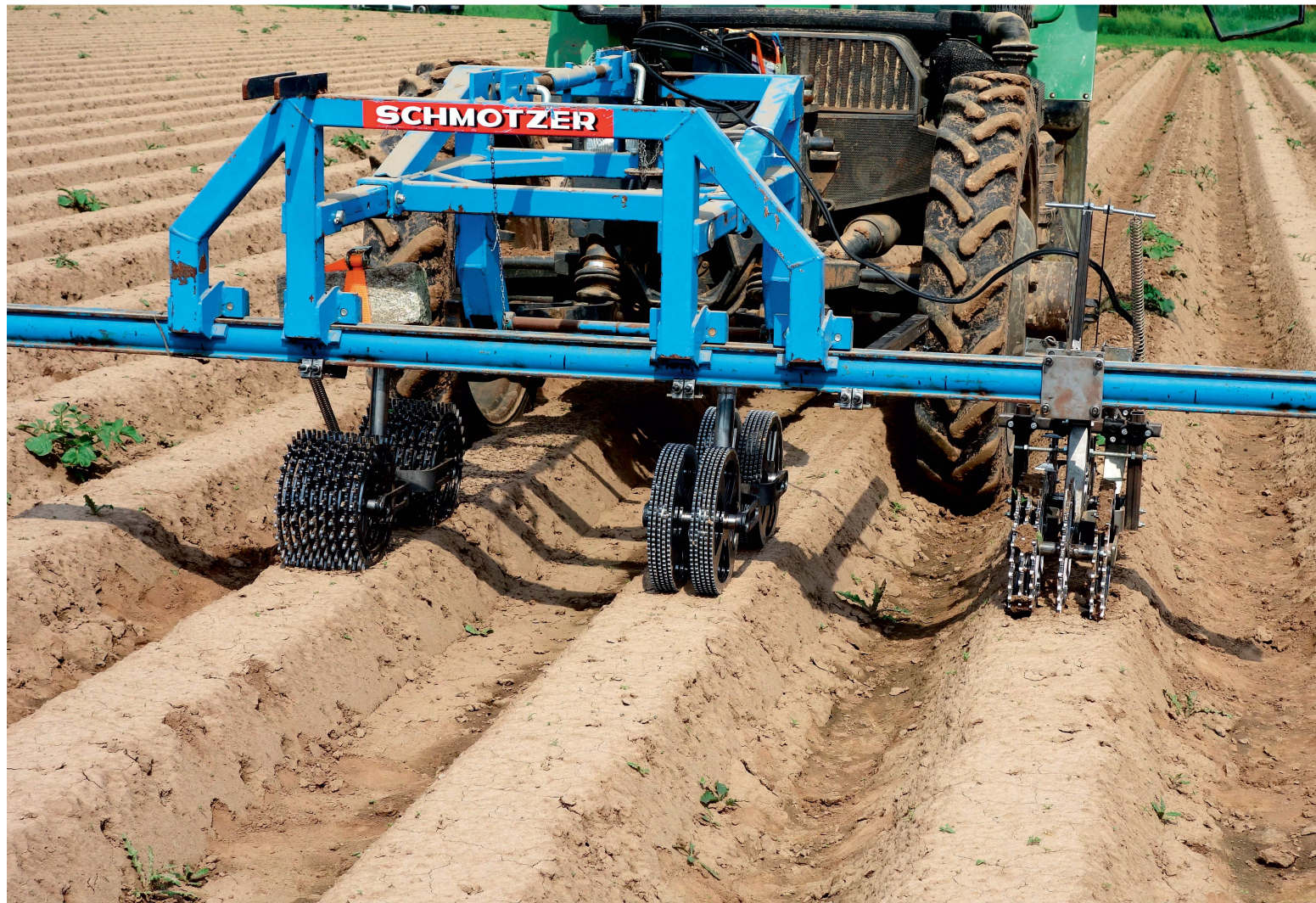
Das Start-up-Unternehmen Dulks stellte anlässlich der Agritechnica verschiedene Hackeinheiten vor, die an gängigen Hackrahmen montiert werden können. Bild: Dulks
