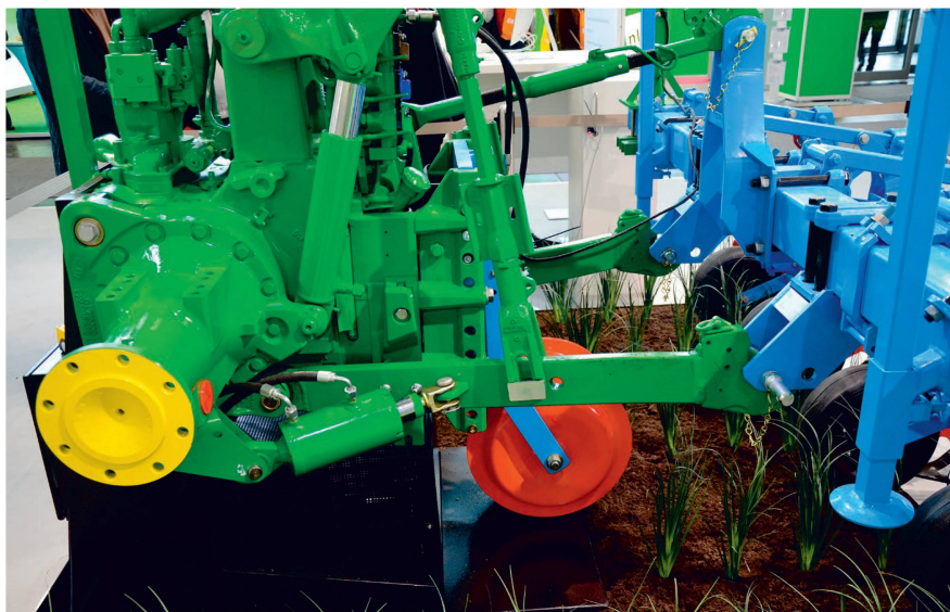
John Deere kommt mit einer automatischen Hackgerätesteuerung auf den Markt, die das Hackgerät über die Unterlenker steuert. Bild: R. Hunger
