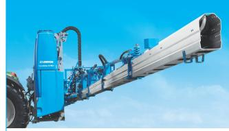
Mit den Sirius Feldspritzen findet jeder Landwirt die passende Pflanzenschutztechnik für seinen Betrieb: von der Sirius 8 als solidem, leistungsstarkem Basismodell bis hin zur elektronisch geregelten Sirius 10 mit Alurohrgestänge, komfortabler Ausstattung, zahlreichen Erweiterungsoptionen und Arbeitsbreiten von bis zu 30 Metern. Viele Vorteile für Sie:
