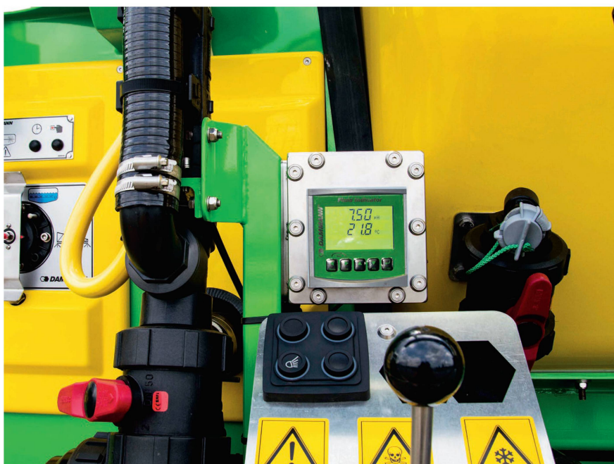
Der Fluid Indicator misst den pH-Wert und die Wassertemperatur und zeigt dem Anwender die Ergebnisse auf dem Monitor an. Bild: Dammann Fluid Indicator
