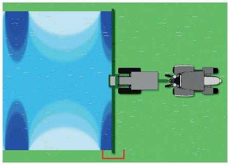
Mit einer Stabilisierung der Gestängebewegungen will Amazone in erster Linie über- oder unterversorgte Teilflächen eliminieren. Bild: Amazone SwingStop
