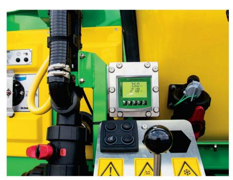
Der Fluid Indicator misst den pH-Wert und die Wassertemperatur und zeigt dem Anwender die Ergebnisse auf dem Monitor an. Bild: Dammann Fluid Indicator
