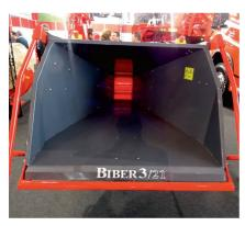
Eschlböck-«Biber»: Die Steuerbügel rund um den Einzug erhöhen Komfort und Sicherheit.
