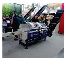
Sägespalter «RCA 330 Joy» von Tajfun, mit Joystick-Steuerung.
