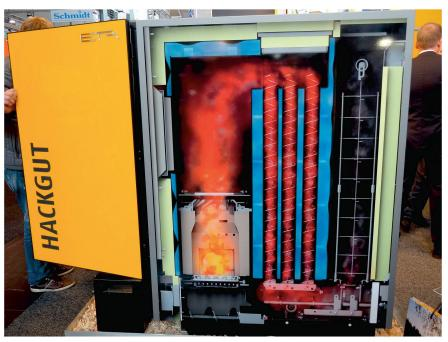
Kessel der Serie «Eta eHack» mit integriertem, elektrostatischem Staubfilter (rechts). Bilder: C. Brüggemann
