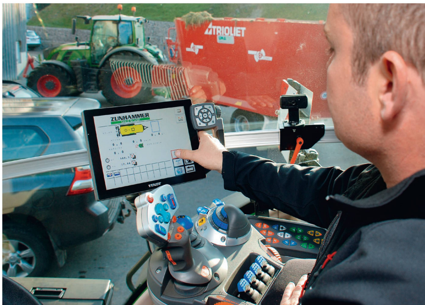
Der Touchscreen ist ein Ein- und Ausgabegerät, bei dem ein Computer oder eine Maschine per Fingertipp oder -berührung direkt gesteuert werden kann. Bild: röt
