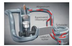
Funktionsweise eines Wastegate-Turboladers. Durch das Bypassventil strömt das Abgas neben dem Turbolader hindurch direkt ins Auspuffrohr. Schema: zvg
