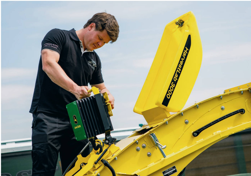
Die Nahinfrarot-Spektroskopie ist ein nahezu ideales Verfahren, Inhaltsstoffe von Futtermitteln schnell, einfach und mit geringem Aufwand zu bestimmen. Bild: John Deere
