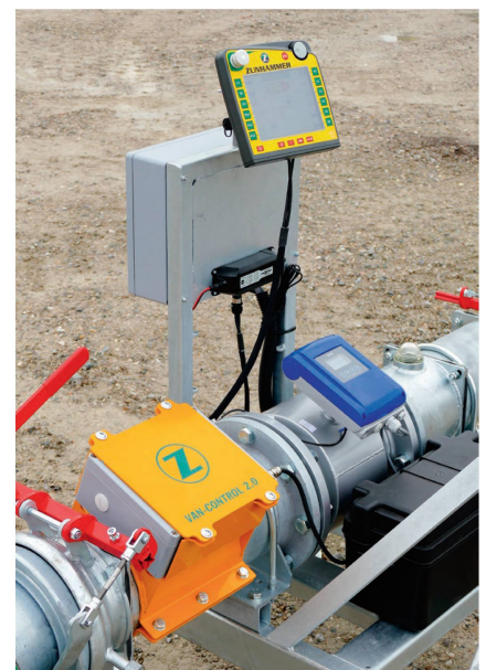
NIR-Sensoren können mithelfen, die Gülle gezielter auszubringen. Bild: Zunhammer
