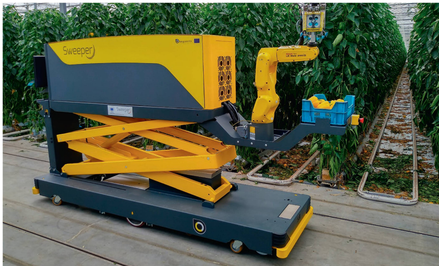
Der dreidimensional bewegliche Roboter ist auf einer mobilen und höhenverstellbaren Plattform aufgebaut.
