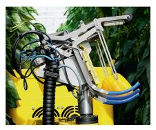
«Sweeper» entdeckt, positioniert und ergreift Peperoni und trennt die Frucht von der Pflanze ab. Bilder: A. Bakker, sweeper-robot.eu
