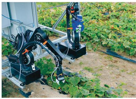
Auf der Zielgeraden – Leichtmodul-Roboter sind scharf auf Gurken. Bild: Fraunhofer-Institut
