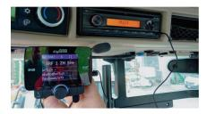
Der «DAB+»-Empfänger übergibt hier das Radiosignal via «AUX-In»-Buchse ans bestehende Radio weiter.
