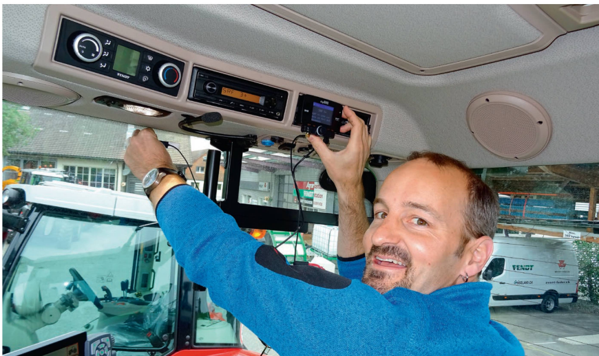
Beat Schmid installiert einen «DAB+»-Empfänger an einem bestehenden Traktor-Radio.
