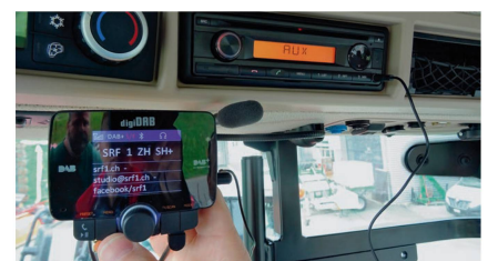
Der «DAB+»-Empfänger übergibt hier das Radiosignal via «AUX-In»-Buchse ans bestehende Radio weiter.
