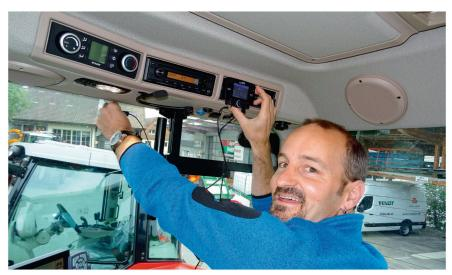
Beat Schmid installiert einen «DAB+»-Empfänger an einem bestehenden Traktor-Radio. Bilder: R. Engeler
