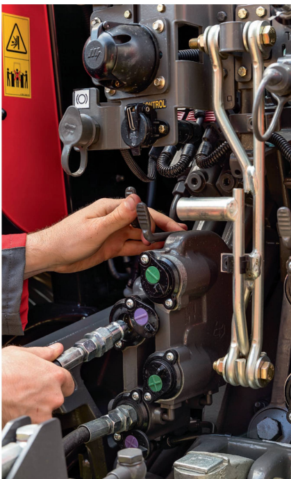
Für das Load-Sensing-System sollte man sich entscheiden, wenn man Geräte mit einem hohen Leistungsbedarf anhängt.
