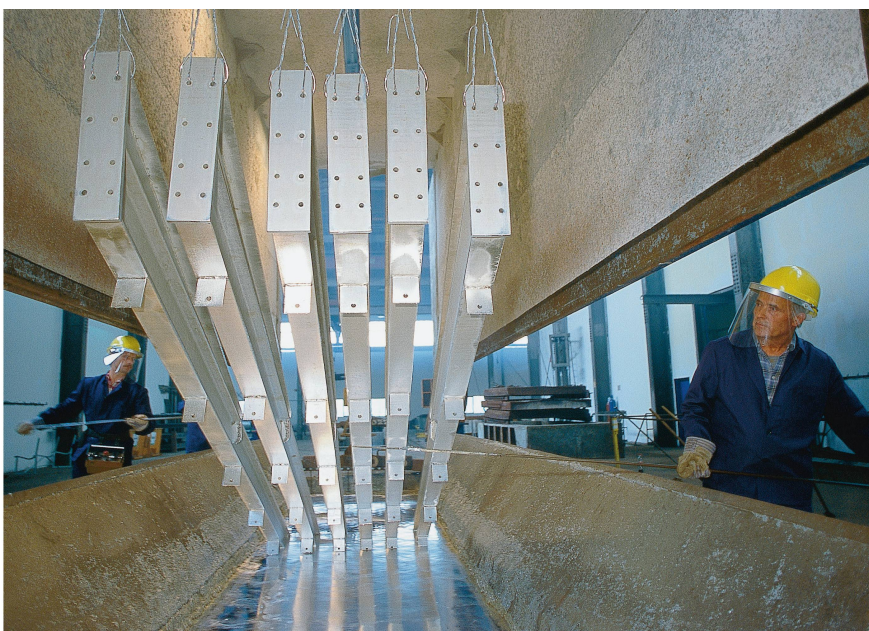
Hier werden frisch verzinkte Stahlteile aus dem Zinkbad gezogen. Bilder: zvg
