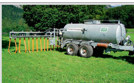
6000-Liter-Fass mit Schleppschl. 12 m
