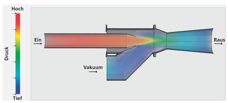
Ejektor-Vakuum-System nach dem Venturi-Prinzip. Der Druck nimmt von links kommend in der Düse ab und ist in der Mitte am kleinsten. Somit ist am kleinsten Querschnitt ein Unterdruck und die Flüssigkeit wird herausgezogen. Danach steigt der Druck wieder an. Schema: zwg
