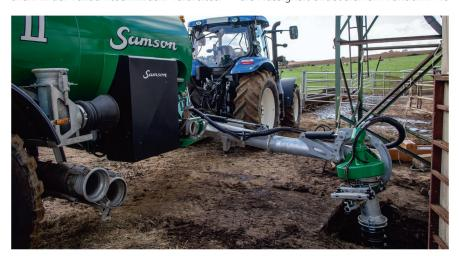
Das Ejektor-System von Samson erzeugt ein sehr grosses Vakuum. Damit ist das Befüllen des Fasses selbst aus grossen Tiefen möglich. Bild: zvg
