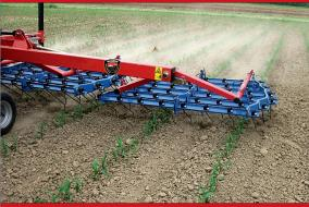
Die einzelnen Zinken sind an fünf oder sechs Zinkenbalken oder Zinkenleisten angebracht und ergeben ein Striegelfeld. Bei diesem Striegel sind die Striegelfelder beweglich an vier Ketten am pendelnden Tragrahmen aufgehängt; daher sind Bewegungen in der Höhe und quer zur Fahrrichtung möglich. Zusätzlich sind die Zinkenfelder durch Zweischeibenlager in sich verwindbar und passen sich dem Boden gut an. Mittels manueller oder hydraulischer Zinkenverstellung wird die Aggressivität eingestellt.
