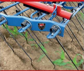
Striegelzinken haben unterschiedliche Formen, Längen und Durchmesser und bestehen aus unterschiedlichen Stählen. Entsprechend ist auch die Kraft für eine bestimmte Auslenkung der Zinken in Fahrrichtung (Längsrichtung) oder quer zur Fahrrichtung (Querrichtung) unterschiedlich. Längere Zinken gleichen Bodenunebenheiten besser aus.
