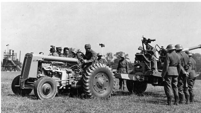
Das Zugfahrzeug Hürlimann «4 T 42» von 1932 ist mit einem 40 PS starken Petrolmotor Hürlimann «4 B 100» ausgestattet und hat ein 5-Gang-Getriebe, Differenzialsperre und Innenbackenbremsen auf den Hinterrädern.
