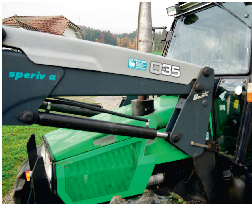
«Man sieht, was vorne passiert», sagt Raphael Elmiger zum Vorteil der schräg abfallenden Motorhaube; der Frontlader ist nachträglich angebaut worden.
