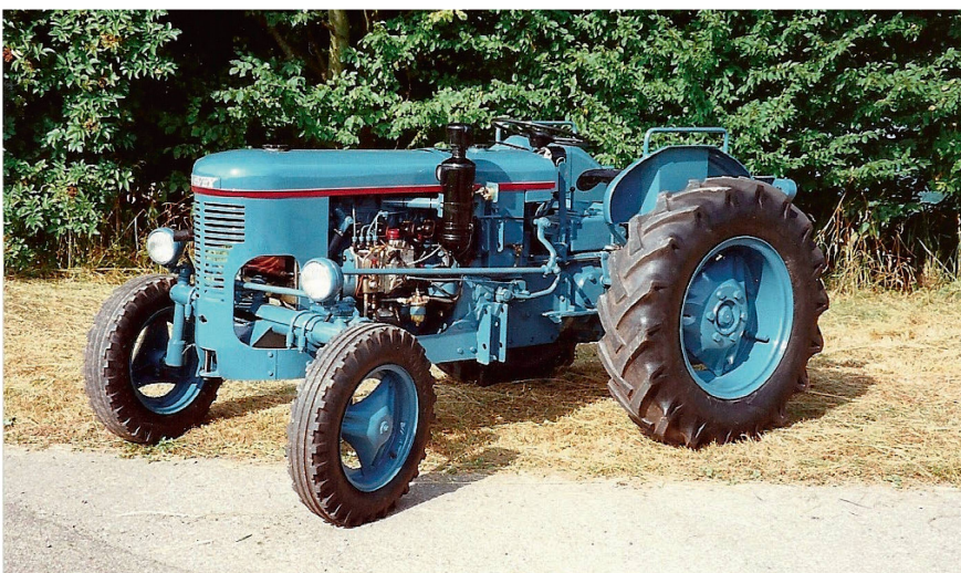
Die Vevey-Traktoren zählten schweizweit zu den fortschrittlichen Traktoren: 3-Punkt-Hydraulik, normierte Zapfwelle, Spur-Verstellräder hinten und vorne waren Serienausüstung.
