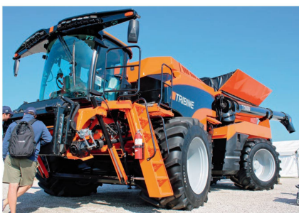
Dieser knickgelenkte Drescher von Tribine mit 35-m 3 -Korntank war ein Blickfang.
