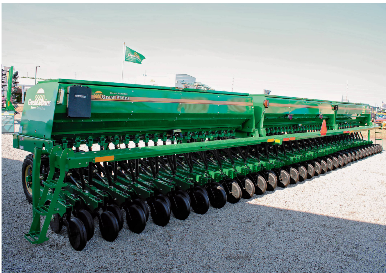
Eine Sämaschine von Great Plains, geeignet für den Einsatz im grossen Weizengürtel in den USA. Bilder: H. Süss
