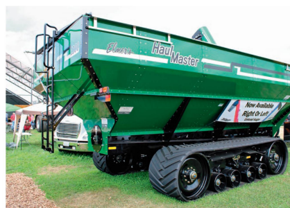
Mit Raupenlaufwerken sind auch Überlade-wagen ausgestattet.
