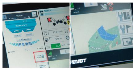
Im Isobus-Terminal des Traktors wird einerseits die Teilbreitenschaltung mit den 12 Teilbreiten angezeigt (Bild links) und andererseits auch, wo im vorher abgemessenen Feld schon Dünger gestreut worden ist und wo nicht (Bild rechts).
