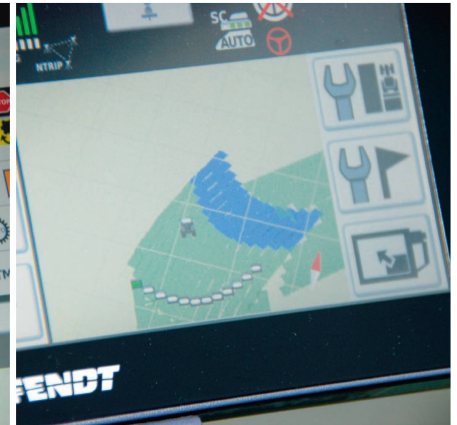
Im Isobus-Terminal des Traktors wird einerseits die Teilbreitenschaltung mit den 12 Teilbreiten angezeigt (Bild links) und andererseits auch, wo im vorher abgemessenen Feld schon Dünger gestreut worden ist und wo nicht (Bild rechts).
