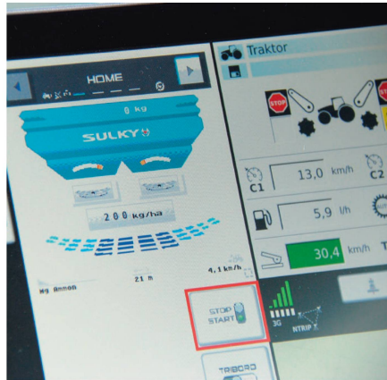
Im Isobus-Terminal des Traktors wird einerseits die Teilbreitenschaltung mit den 12 Teilbreiten angezeigt (Bild links) und andererseits auch, wo im vorher abgemessenen Feld schon Dünger gestreut worden ist und wo nicht (Bild rechts).
