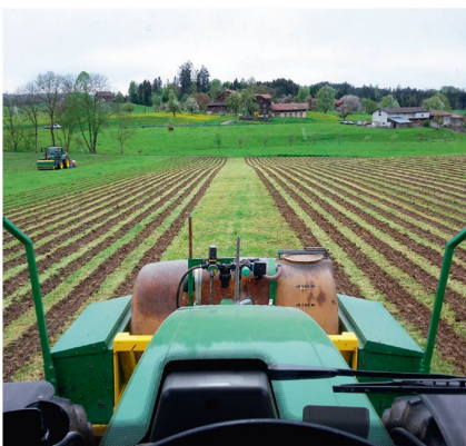
Im Lohnunternehmen Hofstetter kommen auch Lenksysteme zum Einsatz. So etwa bei der Streifenfrässaat. Bild: zvg
