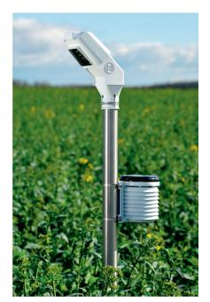
Der «Field Sensor» von Bosch besteht aus einem ganzen Set von Sensoren, untergebracht in einem Pfahl.
