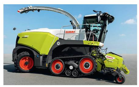
Eine goldene Auszeichnung erhielt Claas für das Raupenlaufwerk «Terra Trac», das speziell für den Feldhäcksler «Jaguar 960» adaptiert wurde, um bei Kurvenfahrten den Schereffekt zu verringern.
