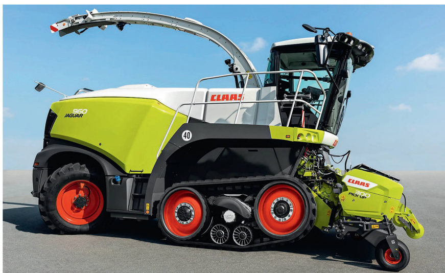
Eine goldene Auszeichnung erhielt Claas für das Raupenlaufwerk «Terra Trac», das speziell für den Feldhäcksler «Jaguar 960» adaptiert wurde, um bei Kurvenfahrten den Schereffekt zu verringern.
