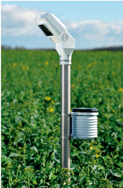
Der «Field Sensor» von Bosch besteht aus einem ganzen Set von Sensoren, untergebracht in einem Pfahl.
