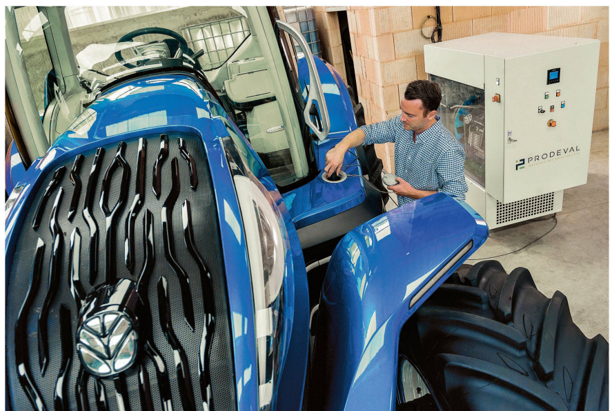
Ein Methan-Antrieb benötigt ein höheres Tankvolumen. Grund ist die geringere Energiedichte von Methan gegenüber Dieseltreibstoff.
