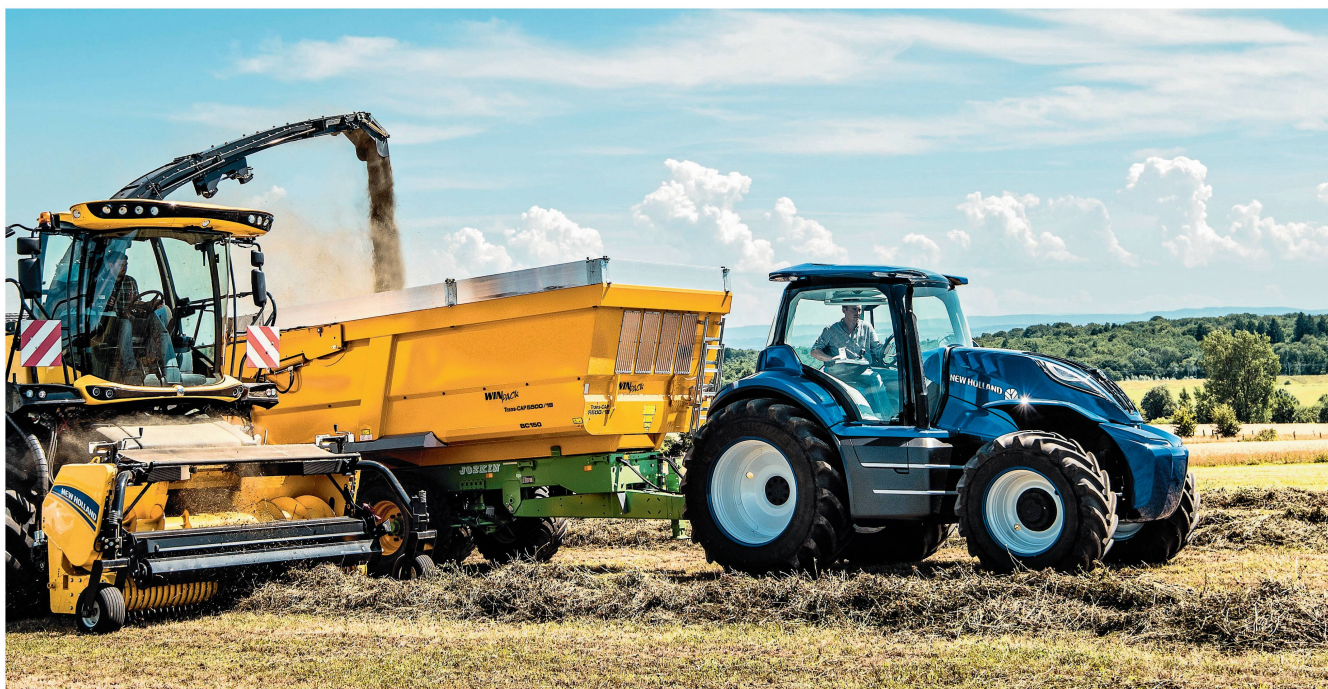
Vorerst werden Motorenkonzepte auf Methan-Basis in Grosstraktoren auf ihre Praxistauglichkeit geprüft. Bilder: CNH
