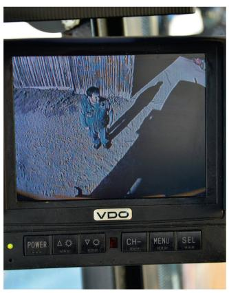
Rückfahrkameras ermöglichen den Einblick in den rückwärtigen Raum. Auf dem Bildschirm in der Kabine ist die Person, die sich hinter der Maschine befindet, deutlich erkennbar. Bilder: Ruedi Hunger
