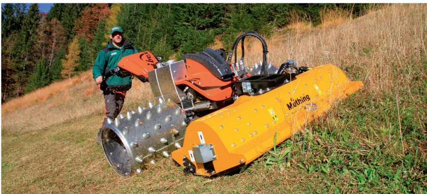
Der «23-PS-Benzineinspritzer» machte auch mit dem 1,6 m breiten Mulcher am Steilhang eine gute Figur.
