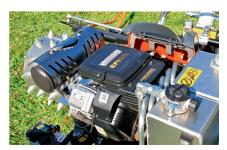
Der «Vanguard V-Twin»-Zweizylinder-Viertakt-Motor von Briggs & Stratton leistet 23 PS.
