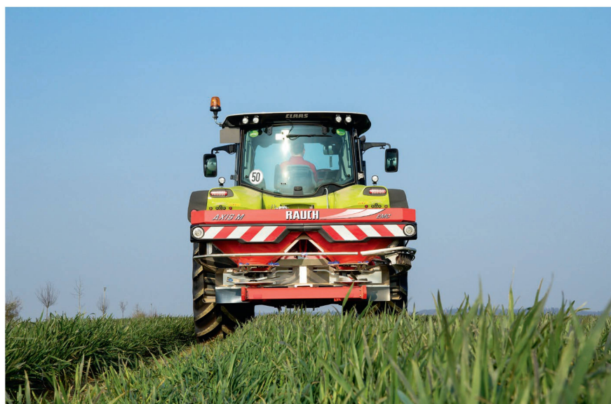
Radar-Sensoren messen bei Rauch und Amazone die ausgeworfene Düngermenge. Bild: Rauch
