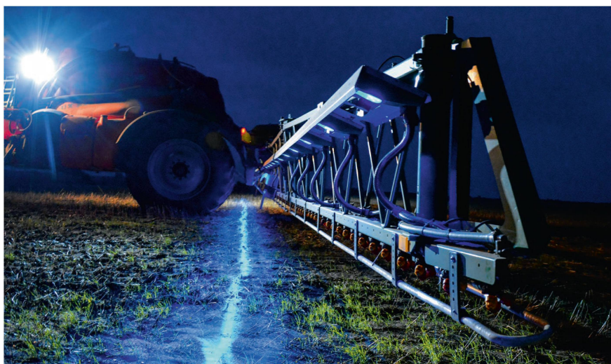
Dank Fluoreszenz-Sensoren kann der Spritzmittelaufwand auf Einzelpflanzen reduziert werden. Bild: Amazone
