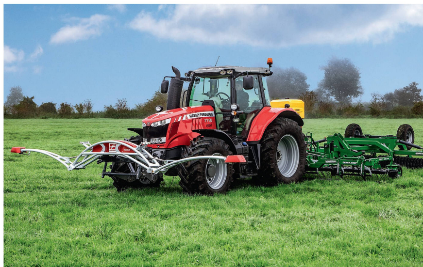
Optische Sensoren werden zur Düngung, beim Pflanzenschutz und bei der Grünlandnachsaat eingesetzt. Bild: Fritzmeier/Isaria
