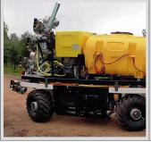
Das elWObot-Projekt ist ein Plantageroboter, der autonom durch Obst- und Weinbauplantagen fahren kann. Regelmässige und wiederkehrende, monotone Aufgaben können von ihm übernommen werden. Dank einfachen und robusten Komponenten ist das Fahrzeug prädestiniert für den autonomen Einsatz.
