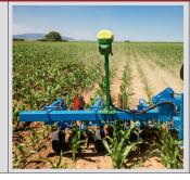
Beim AutoTrac berechnet eine auf der Hackmaschine montierte Kamera vorausschauend die Spur entlang der Pflanzenreihe. Die Seitenverschiebung der Hackmaschine erfolgt traktorseitig über die hydraulischen Seitenstabilisatoren am Unterlenker.
