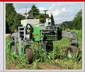
Dieses Fahrzeug ist echt «selbstfahrend». Es ist ein autonomes Roboter-System, das sich vorwärts, rückwärts und seitwärts bewegt. Bereits ist ein Trend erkennbar, dass die Plattform für verschiedene unterschiedliche Anwendungsmodule (App-Konzept) eingesetzt wird.
