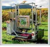
Der Phenobot ist ein autonomer Roboter für die Anwendung im Weinbau. Die bei der Fahrt durch die Reihen von seinem Kamerasystem aufgenommenen Bilder dienen dazu, phänotypische Merkmale zu beurteilen. Der Roboter arbeitet berührungslos und rasch. krautaktoren an den «konventionellen» Landbau wenden.
