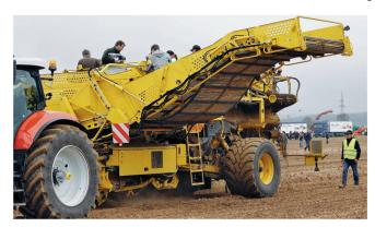
Der neue «Keiler 2L» von Ropa ist mit einem Überladebunker ausgestattet, bei dem die Bunkerwanne und das 3-fach knickbare Entladeband separat angetrieben werden.
