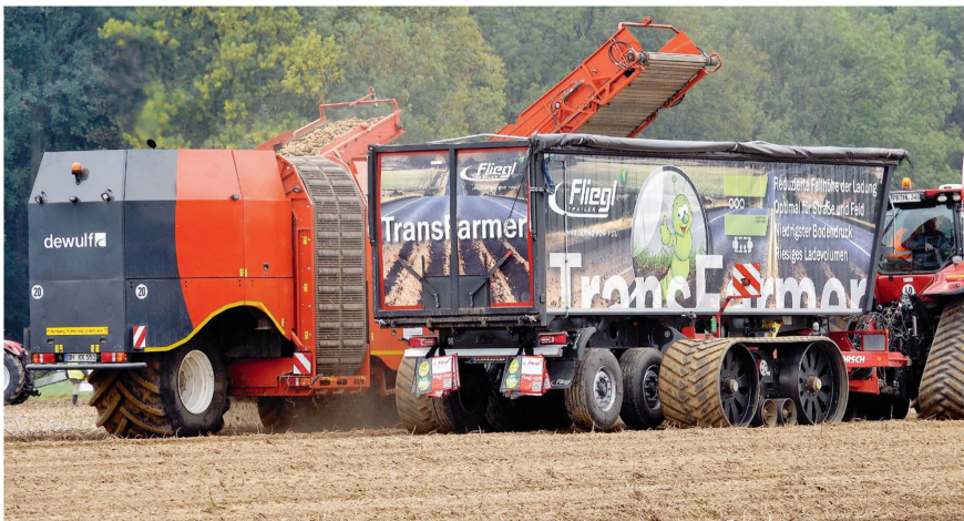
Mit dem «Trailer Lift» von Horsch wird das Gewicht des «TransFarmer»-Sattelauflegers von Fliegl auf zwei grosse Raupenlaufwerke angehoben. Bilder: R. Burkhalter
