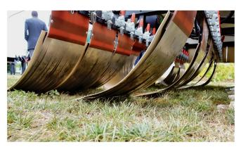
Das neue «Electroherb»-Verfahren von Zasso schädigt das Kraut mit elektrischem Strom und soll einen deutlich geringeren Energieverbrauch realisieren als thermische Verfahren mit Gas.
