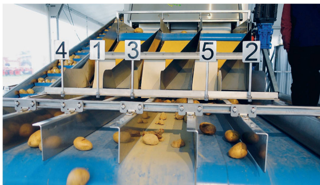
Der optoelektronische Sortierer «Visar Sortop Potatoes» bietet sechs Abgänge, für die beliebige Qualitätskriterien am Touchscreen definiert werden können.
