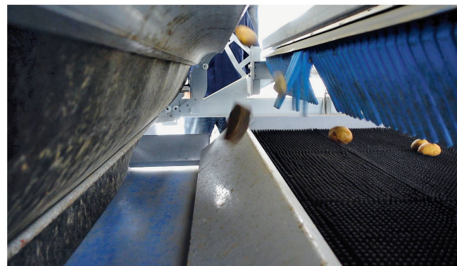
Der optische Sortierer «Tomra FPS» reinigt Feldkartoffeln von Steinen, Kluten und anderen Fremdkörpern mit einer Leistung von bis zu 70 t pro Stunde.
