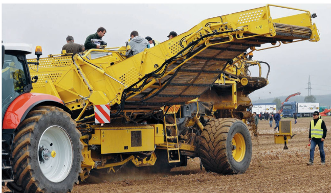
Der neue «Keiler 2L» von Ropa ist mit einem Überladebunker ausgestattet, bei dem die Bunkerwanne und das 3-fach knickbare Entladeband separat angetrieben werden.
