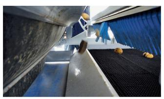
Der optische Sortierer «Tomra FPS» reinigt Feldkartoffeln von Steinen, Kluten und anderen Fremdkörpern mit einer Leistung von bis zu 70 t pro Stunde.
