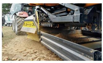
Beim Überladewagen «K3» von Brettmeister wird die während des Überladens abgetrennte Erde in einem Kratzboden-Bunker gesammelt und aufs Feld zurückgeführt.
