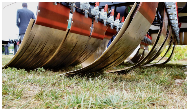
Das neue «Electroherb»-Verfahren von Zasso schädigt das Kraut mit elektrischem Strom und soll einen deutlich geringeren Energieverbrauch realisieren als thermische Verfahren mit Gas.
