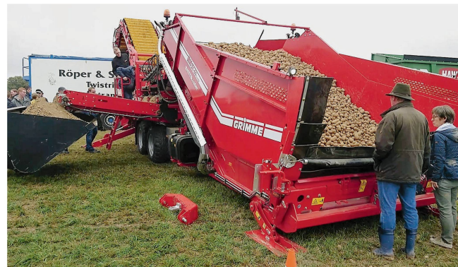
Klassische Feldverladestationen wie der «Clean Loader» von Grimme bieten eine grosse Abscheidefläche und Platz für vier Personen am Verleseband.
