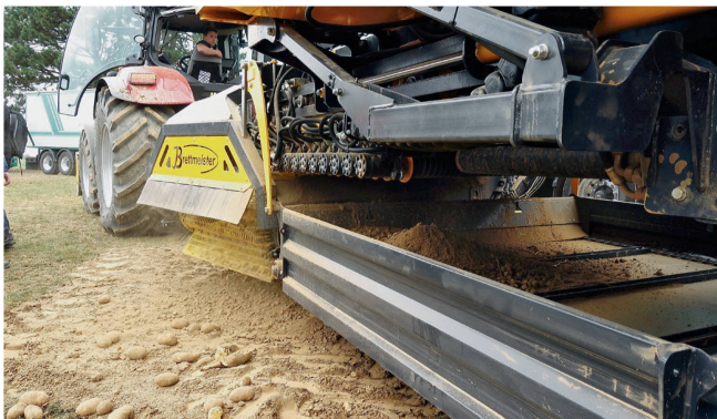
Beim Überladewagen «K3» von Brettmeister wird die während des Überladens abgetrennte Erde in einem Kratzboden-Bunker gesammelt und aufs Feld zurückgeführt.
