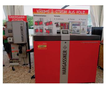
Die kompakt gebaute Kraft-Wärme-Kopplungseinheit (Holzvergaser) von Hersteller Hargassner mit 20 kW elektrischer Leistung.
