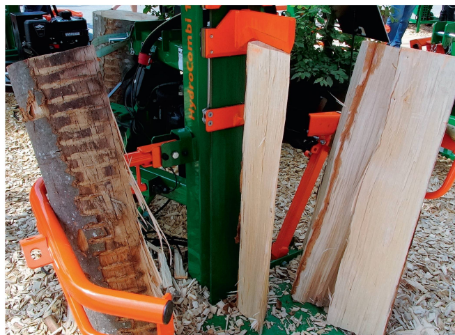
Stehende Langholzspalter müssen mit Hub- und Fangbügeln ausgestattet sein, die das Anheben der Stämme erleichtern und ein Umfallen der Stämme verhindern.
