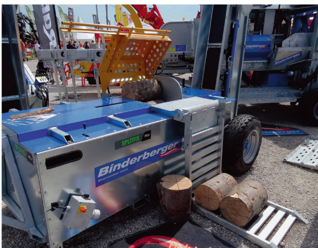
Binderberger zeigte den Prototyp eines Schichtspalters, der vollständig gekapselt ist und so Verletzungsgefahren minimiert.
