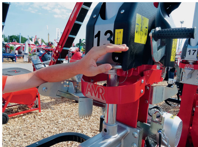
Bei Zweihandbedienungen müssen die Abstände der Bedienhebel so weit entfernt angeordnet sein, dass sie nicht überbrückt werden können.
