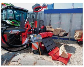
Liegende Grossspalter müssen durch Schutzgitter und Abstände zu den Spaltwerkzeugen sicher bedienbar sein.
