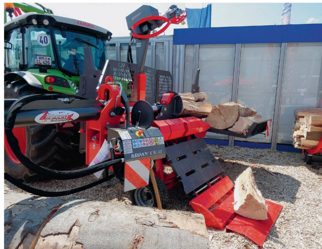
Liegende Grossspalter müssen durch Schutzgitter und Abstände zu den Spaltwerkzeugen sicher bedienbar sein.
