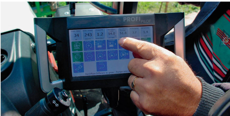
Gesteuert und überwacht wird die Gülleausbringung auf dem Traktor mit der Funkfernsteuerung «ProfiPilot». Für die Anwendung von Thomas Estermann wurde die Steuerung um die Differenz-Erkennung von zwei Durchflussmessungen erweitert.
