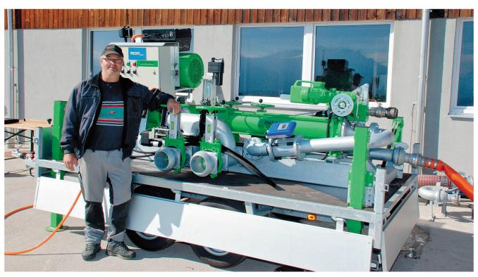
Thomas Estermann aus Hildisrieden LU mit seiner Güllepumpe, die speziell nach seinen Ideen entwickelt worden ist. Mit der Funkfernsteuerung «ProfiPilot» kann er alle Funktionen der Pumpe aus der Ferne steuern. Bilder: röt
