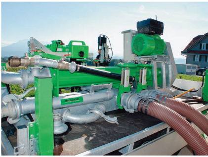
Die Güllepumpe hat sowohl auf der linken als auch auf der rechten Seite Anschlüsse für Gülle und Wasser.
