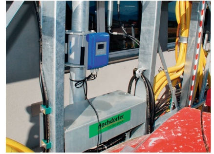
Ein Durchflussmesser ist auf der Pumpe montiert, der andere auf dem Schleppschlauchverteiler. Stellt der «ProfiPilot» eine zu hohe Differenz zwischen den beiden gemessenen Mengen fest, wird die Güllepumpe sofort automatisch abgestellt.
