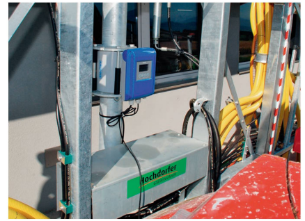
Ein Durchflussmesser ist auf der Pumpe montiert, der andere auf dem Schleppschlauchverteiler. Stellt der «ProfiPilot» eine zu hohe Differenz zwischen den beiden gemessenen Mengen fest, wird die Güllepumpe sofort automatisch abgestellt.
