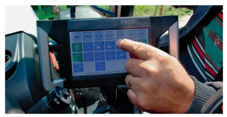
Gesteuert und überwacht wird die Gülleausbringung auf dem Traktor mit der Funkfernsteuerung «ProfiPilot». Für die Anwendung von Thomas Estermann wurde die Steuerung um die Differenz-Erkennung von zwei Durchflussmessungen erweitert.
