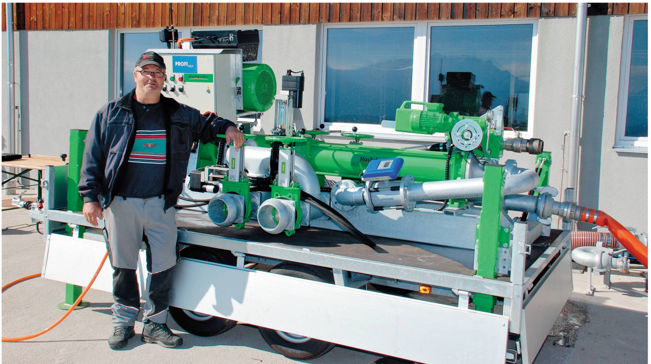
Thomas Estermann aus Hildisrieden LU mit seiner Güllepumpe, die speziell nach seinen Ideen entwickelt worden ist. Mit der Funkfernsteuerung «ProfiPilot» kann er alle Funktionen der Pumpe aus der Ferne steuern. Bilder: röt
