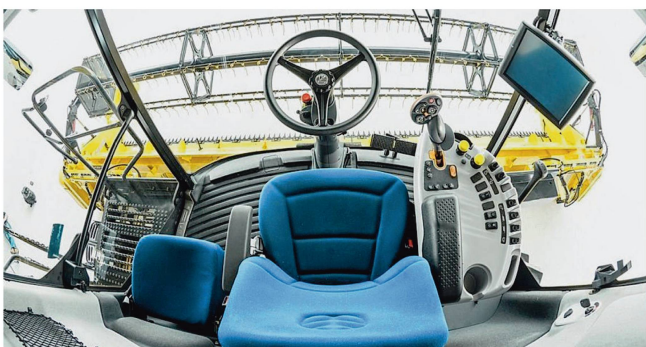
Die neue Kabine bietet viel Fensterfläche, die Bedienelemente stammen aus den grösseren Leistungsklassen.
