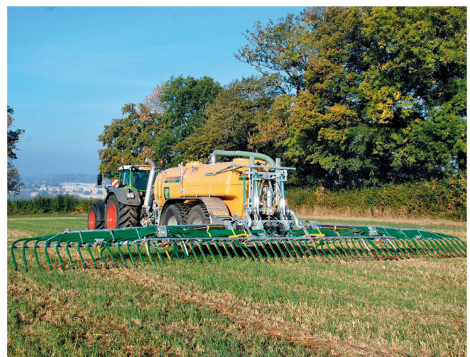
Das neue 16000-Liter-Güllefass mit Schleppschlauchverteiler und NIR-Sensor. Der Betrieb von Fernand Andrey bringt jährlich bis zu 35000 Kubik Gülle aus.
