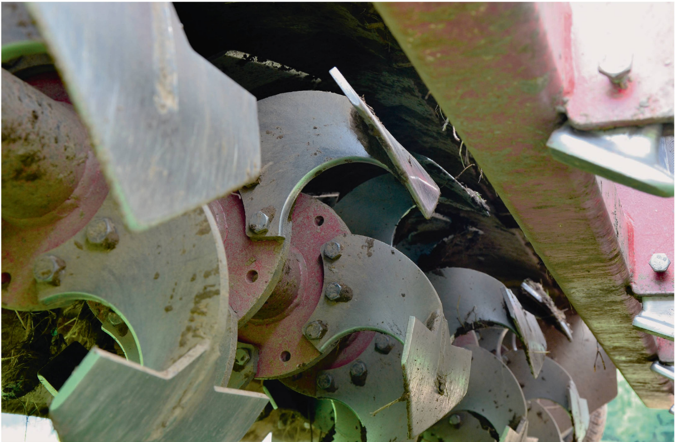
Ein Schlüssel zum Erfolg ist die spezielle Formgebung der «Hobelmesser», die sich im Rotorkreis der Welle drehen. Bilder: R. Hunger
