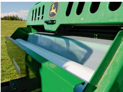
Das Testmodell wurde mit einer Einrichtung zur Folienbindung nachgerüstet.
