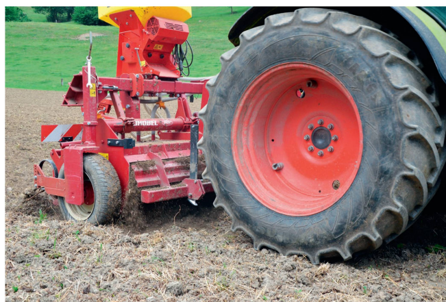
Das auf der Höhe der Rotorwelle platzierte Rad garantiert eine optimale und gleichbleibende Arbeitstiefe.
