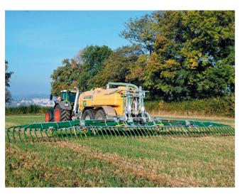
Das neue 16000-Liter-Güllefass mit Schleppschlauchverteiler und NIR-Sensor. Der Betrieb von Fernand Andrey bringt jährlich bis zu 35000 Kubik Gülle aus.
