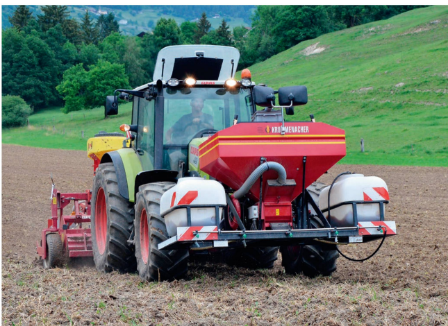
Die aufgelöste Bauart mit Sätank und Applikationstechnik zur Rottelenkung vorne, bringt eine gute Gewichtsverteilung.
