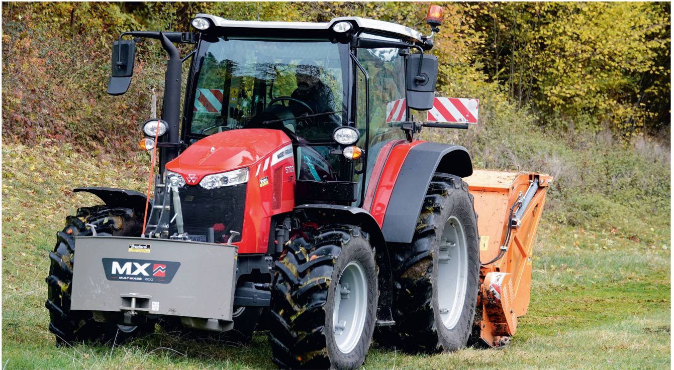
Der MF «5709 Dyna4 Global» stemmt mit 4300 kg Hubkraft auch schwere Anbaugeräte. Bilder: R. Burkhalter
