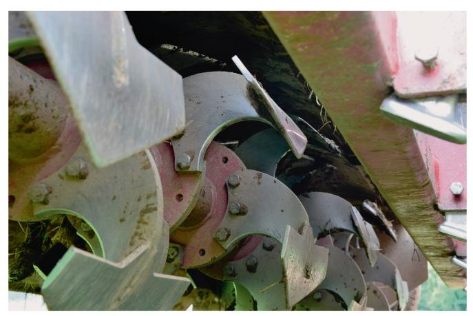
Ein Schlüssel zum Erfolg ist die spezielle Formgebung der «Hobelmesser», die sich im Rotorkreis der Welle drehen. Bilder: R. Hunger
