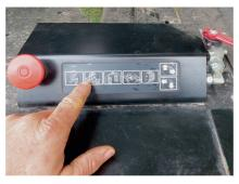
Einige der Funktionen lassen sich über Folientaster auf beiden Kotflügeln steuern.
