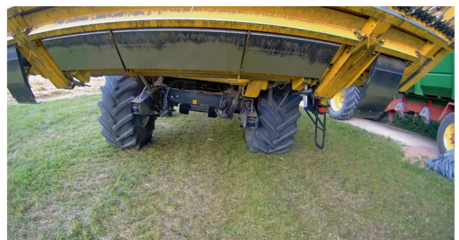
In der «Laterale»-Version kann die ganze Maschine zusätzlich zum «Smart Sieve» bis zu 18% Hangneigung ausgleichen.
