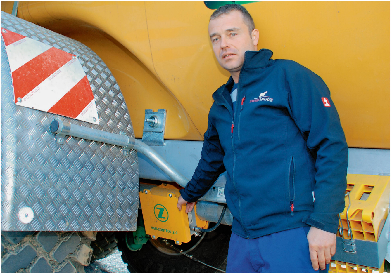
Pascal Grützner, Mitarbeiter von Fernand Andrey, zeigt den «Van-Control 2.0». Der NIR-Sensor, der bei der Pumpleitung angebracht ist, misst während des Befüllens den Nährstoff-Gehalt der Gülle im Sekundentakt. Bilder: röt
