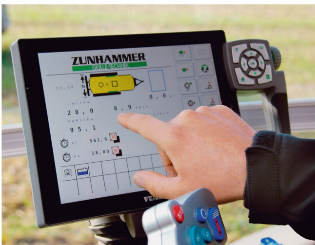
Beim Ausbringen hat der Fahrer jederzeit die Kontrolle über die ausgebrachte Menge Gülle mit deren Nährstoffgehalt sowie der Fahrgeschwindigkeit.
