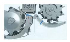
Sowohl die Hauptdreschtrommel (links) als auch der Zentrifugalabscheider (rechts) bieten Verstellmöglichkeiten von Drehzahl und Korbabstand.
