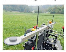
Auf dieser Schiene sind die Empfänger für die diversen Signale montiert.
