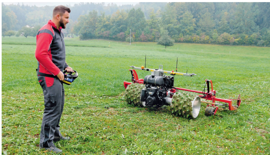
Teilautonom unterwegs: Eine Bedienperson überwacht den Rapid «Cosmos» bei Mäharbeiten. Aufgrund fehlender Stopp-Sensoren darf das Gerät nicht vollständig autonom arbeiten.
