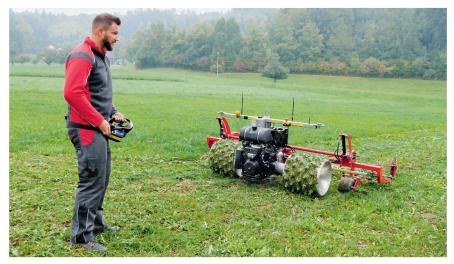
Teilautonom unterwegs: Eine Bedienperson überwacht den Rapid «Cosmos» bei Mäharbeiten. Aufgrund fehlender Stopp-Sensoren darf das Gerät nicht vollständig autonom arbeiten. Bilder: R. Engeler
