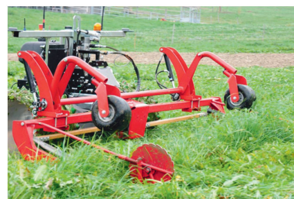
Zwei frei pendelnde Räder dienen als Hilfsachse und werden bei Bedarf über zwei Hydraulik-Zylinder nach unten gedrückt, sodass das Anbaugerät ausgehoben wird.
