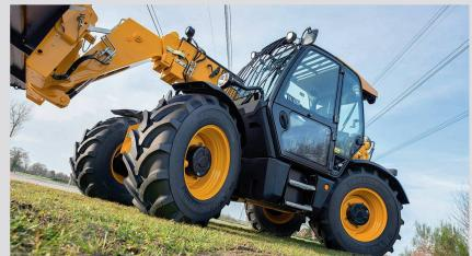
der verfügbaren Größen hat der Hersteller nun von vier auf acht verdoppelt. Die neuen Größen sind 340/80R 18IND, 400/70R 24IND, 400/80R 24IND und 440/80R 28IND. Auch die Baureihe «Endurion» wurde für Teleskoplader, kompakte Radlader und Baggerlader entwickelt, jedoch hauptsächlich für Anwendungen auf hartem Boden. Von dieser Baureihe gibt es sechs neue Größen und zwar 340/80R 18IND, 400/70R 18IND, 340/80R 20IND, 400/70R 20IND, 400/70R 24IND und 400/80R 24IND.
