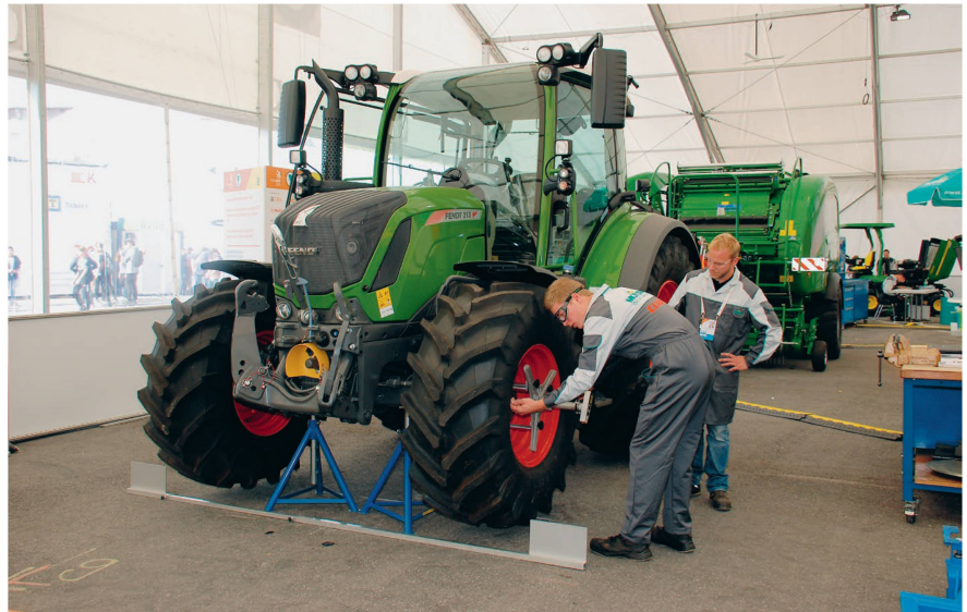
Bei der Aufgabe «Mechanische Antriebe» mussten die Kandidaten die Spur und den Lenkereinschlag eines Traktors richtig einstellen.
