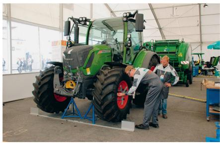
Bei der Aufgabe «Mechanische Antriebe» mussten die Kandidaten die Spur und den Lenkereinschlag eines Traktors richtig einstellen.
