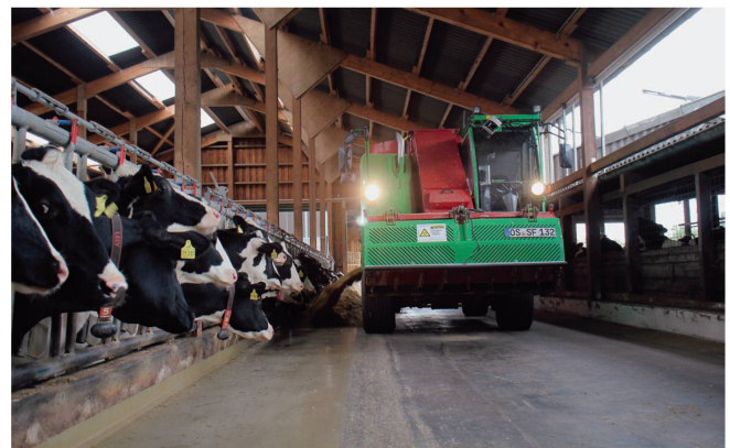
Demnächst autonom soll der selbstfahrende Futtermischwagen «Veri-Q» von Strautmann unterwegs sein. Bild: Strautmann
