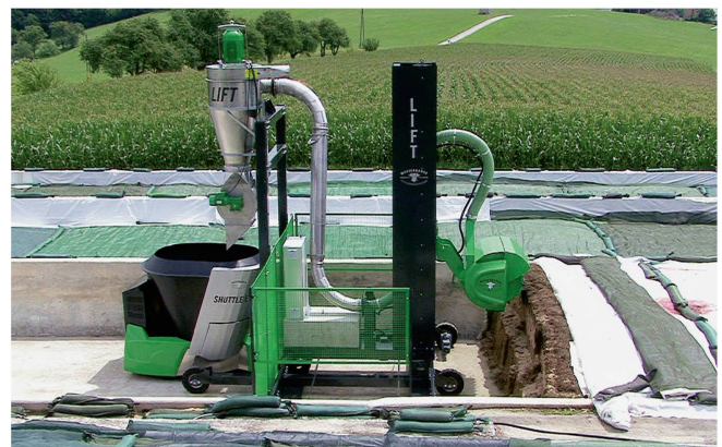
Wasserbauer hat zum Fütterungsroboter ein automatisches Entnahme-System für Fahrsilos entwickelt. Bild: Wasserbauer
