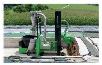
Wasserbauer hat zum Fütterungsroboter ein automatisches Entnahme-System für Fahrsilos entwickelt. Bild: Wasserbauer
