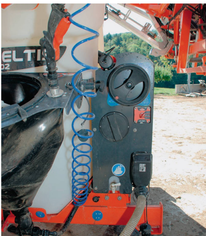
Mit dem Multifunktionshandrad und den beiden Absperrventile ist eine einfache Bedienung ohne viele Handgriffe möglich.
