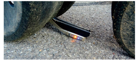
Bodensensoren erfassen während der Saat die Feuchte, die Temperatur und den Gehalt an organischer Substanz im Boden.
