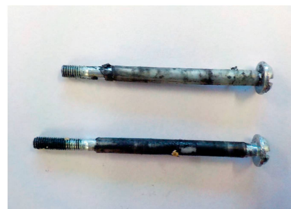
Beim Produkt der Marke «Hurricane» brach im Test die Halteschraube des Vergasers.
