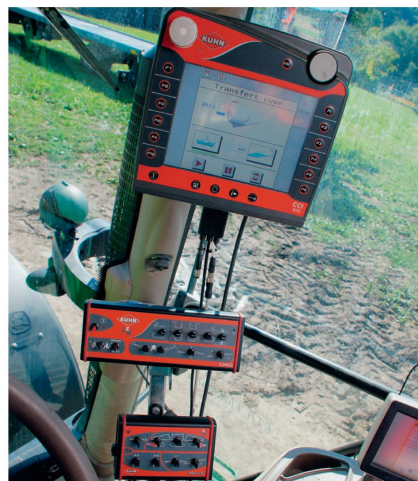
Gesteuert wird die Spritze über ein «CCI 200»-Isobusterminal (oben) und die beiden Bedienboxen «CH10» und unten «Isoclick».
