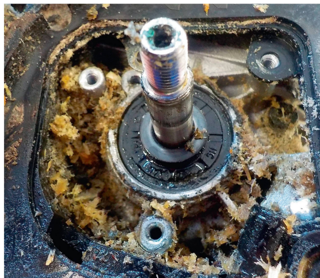
Unterhalb dieser Ölpumpe zeigt sich ein stark verschmutztes Kurbelgehäuse.
