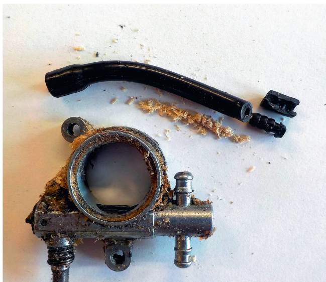
Diese Ölpumpe mit verstopfter Schmierölleitung ging in diesem Test defekt.
