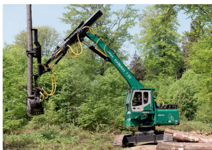
Der Raupen-Harvester «T50», ein Gemeinschaftsprojekt von Sennebogen und Impex, kann ganze Bäume stehend entnehmen.
