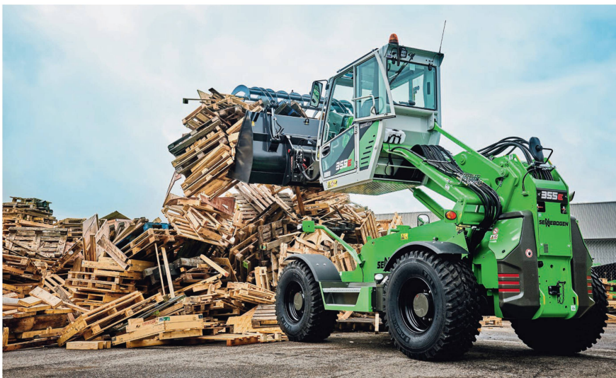
Der Teleskoplader «355» mit hochfahrbarer Kabine ermöglicht dem Fahrer eine exzellente Rundumsicht. Bilder: Sennebogen
