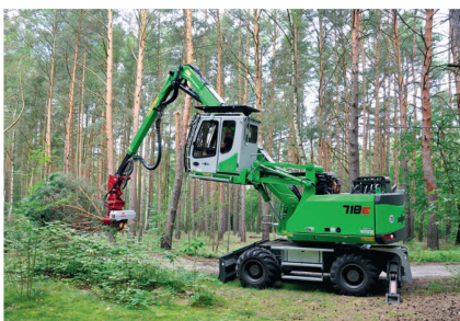
Ausgestattet mit Anbaugeräten von «van Osch» erreicht der Forst-Teleskopkran «718E» alles im Umkreis von 13 Metern.
