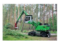
Ausgestattet mit Anbaugeräten von «van Osch» erreicht der Forst-Teleskopkran «718E» alles im Umkreis von 13 Metern.
