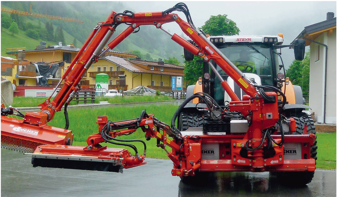
Die grosse seitliche Ausladung und das hohe Gewicht stellen hohe Anforderungen an die Vorderachse. Bilder: R. Hunger, Kotschenreuther, Lindner
