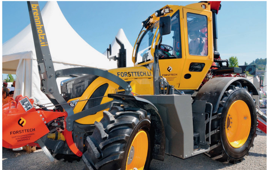
Der «Wario» ist ein multifunktionales Fahrzeug auf der Basis eines Fendt Vario 700. Auffallend die komplett neue Fahrerkabine.
