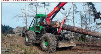
Die 4-Rad-Modelle sind mit 110, 129 oder 151 kW starken Iveco-Dieselmotoren ausgerüstet. Der Antrieb erfolgt zweistufig über einen hydrostatischen Antrieb. Die Knicklenker sind mit NAF-Planetenstarrachsen mit zuschaltbarem 100%-Sperrdifferential ausgestattet. Schliesslich verfügen die Traktoren über eine ROPS/FOPS/OPS-Sicherheitskabine mit Komfort-Dreh-Fahrersitz.
