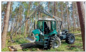
Pfanzelt baut in die 4-Rad-Modelle 133-kW- oder 174-kW-Deutz-Motoren ein. Diese 6-Zylinder erfüllen die Abgasvorschriften mit einem SCR-Katalysator.
