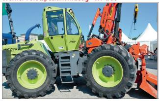
Die 4×4-Version des «WF trac» zeichnet sich aus durch konsequente Umsetzung leistungsfähiger Grundsätze für ein Forstfahrzeug. Das KWF-zertifizierte Fahrzeug kann mit einer grossen Ausrüstungsvielfalt optimal ausgestattet werden. Neben einer 10-t-Winde mit bis zu 150 m Seil macht die schnelle Umrüstung mit einem Harvester-Aggregat den WF trac zum Vollernter.
