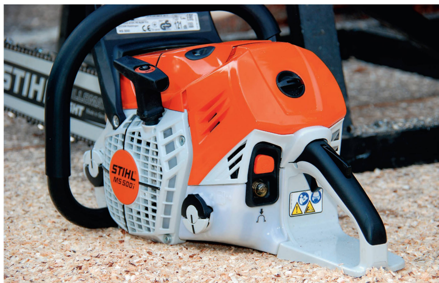
Zur Bedienung der Stihl «MS 500i» gibt es lediglich eine Stopptaste (oranger Knopf) und etwas unterhalb davon die Kraftstoff-Handpumpe, den so genannten «Purger». Bilder: röt/zvg
