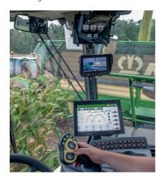
Dank einer kamerabasierten 3D-Bildanalyse kann jedes Abfuhrfahrzeug im Parallelbetrieb seitlich automatisch beladen werden.
