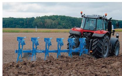
Lemken hat die Pflugbaureihe «Juwel 7 M» um eine wirtschaftliche Variante mit sechs Scharen erweitert. Der Anbaupflug verfügt über ein hydraulisches «UniTurn»-Drehwerk mit mechanischer Neigungseinstellung. Die kurze Drehachse mit 120 mm Durchmesser soll laut dem Hersteller für eine präzise und sichere Wendung sorgen. Mit einem Rahmendurchmesser von 120 mm ist der
