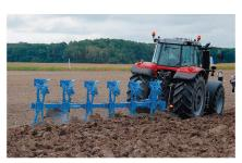
Lemken hat die Pflugbaureihe «Juwel 7 M» um eine wirtschaftliche Variante mit sechs Scharen erweitert. Der Anbaupflug verfügt über ein hydraulisches «UniTurn»-Drehwerk mit mechanischer Neigungseinstellung. Die kurze Drehachse mit 120 mm Durchmesser soll laut dem Hersteller für eine präzise und sichere Wendung sorgen. Mit einem Rahmendurchmesser von 120 mm ist der
