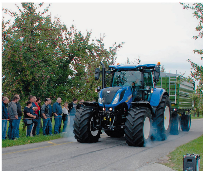
Vollbremsung mit dem hydraulischen Zweileiter-Bremssystem «H2L» von Paul Forrer. Bild: röt
