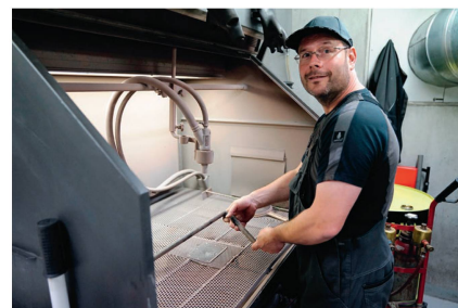
In der Sandstrahlkabine erfolgt die Entlackung oder Entfernung von Rost.
