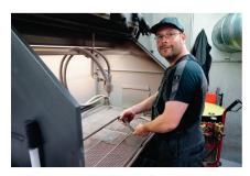
In der Sandstrahlkabine erfolgt die Entlackung oder Entfernung von Rost.
