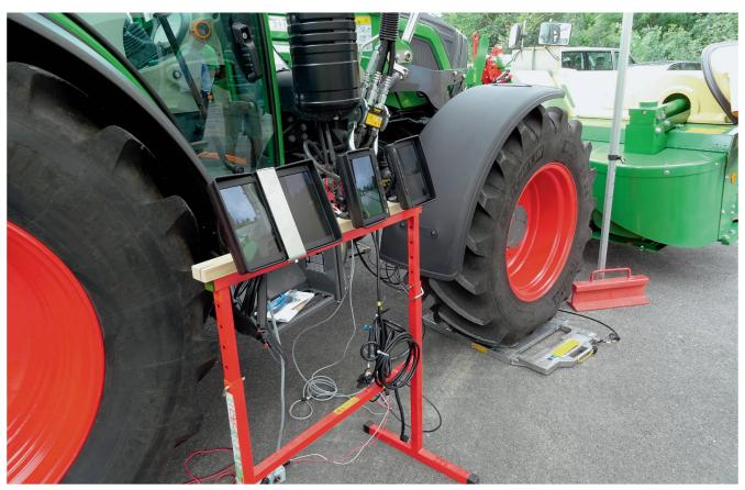
Kamerasysteme sollen den künftig vielleicht ausgedehnteren vorderen Überhang sicherer machen. Die limitierenden Faktoren wie zulässige Achslast oder Tragfähigkeit der Reifen bleiben jedoch und schränken diese mögliche Ausdehnung vor allem bei kleinen und mittleren Traktoren ein. Bild: R. Engeler
