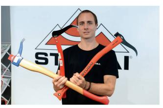
Stubai bietet seine Forstwerkzeuge auch in 2K-Kunststoff an, einem faserverstärkten Kunststoff.
