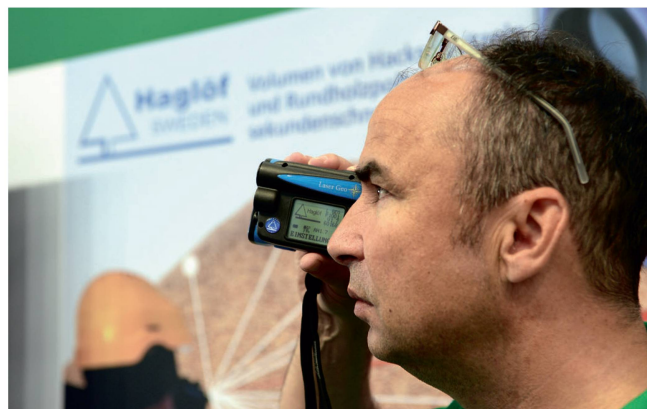
... oder mit dem Lasergerät, das auch Volumina von Schüttgütern erfassen kann.
