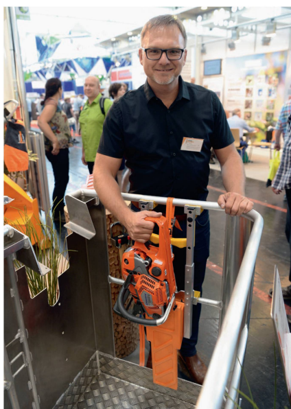
Der Motorsägen-Halter «Toolprotect» kann auf Arbeitsbühnen oder -körben verwendet werden.
