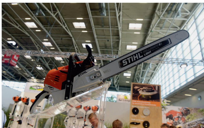
Stihl bringt mit der «MS 500i» die weltweit erste Motorsäge mit elektronisch gesteuerter Einspritzung auf den Markt.
