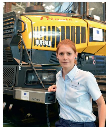
Ein mit Bodenscanner ausgestatteter Rückezug ermittelt und dokumentiert bei jeder Überfahrt den Zustand der Rückegasse.
