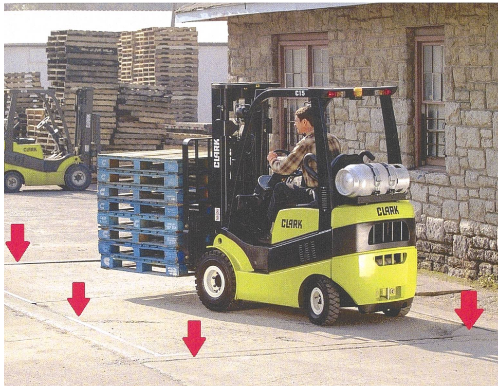
Fugen, Risse, Löcher und Rinnen sind auslösende Momente für Vibrationen die den Fahrer belasten.
