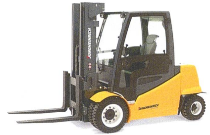
Der «Gegengewichtsstapler», wie er korrekt heisst, hat verhältnismässig kleine Räder.
