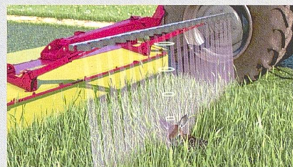
Bringt er nun die Rettung für die Rehkitze? Optisches Infrarotsystem mit LED-Beleuchtung «Sensosafe» von Pöttinger.
