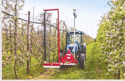
Innovation für den Obstbau: Kamerasystem für das automatisierte Ausdünnen von Blüten oder Früchten von Fruit-Tec Adolf Betz.
