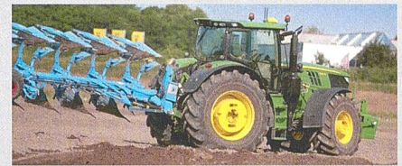
Drehpunktunabhängig und ohne Schrauben zu montieren sind diese neuen Radgewichte «EZ Ballast Wheels» von John Deere.
