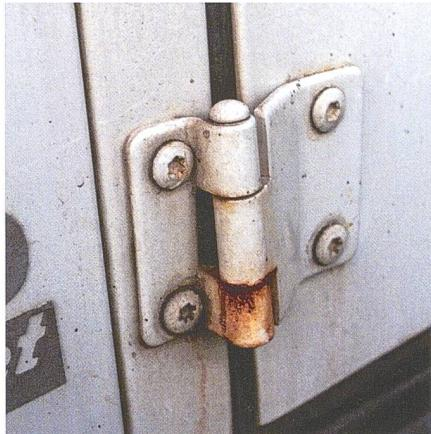
Wenn sich am Türscharnier eines Fahrzeuges mit Spuren von Rostwasser zeigen, entsteht Spiel, und das Scharnier wird bei der amtlichen Kontrolle beanstandet.
