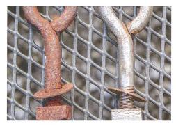
Die vorher ebenfalls stark verrostete Ringschraube rechts wurde für drei Tage in Essig eingelegt und mit Wasser sowie Bürste von jeglichem Rost «befreit».
