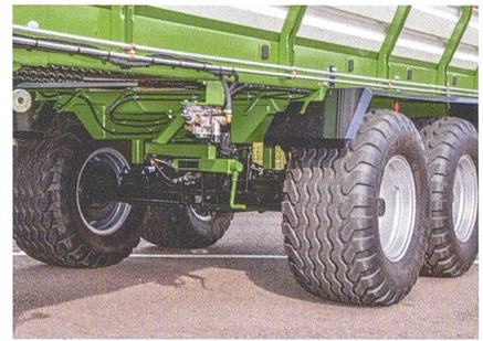
Das Tandemfahrwerk mit Lenkachse garantiert bestmögliche Bodenschonung und ist ringzügig.
