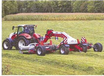
Wird der «Respiro R9» als Mittenschwader eingesetzt, beträgt die Arbeitsbreite 9 m.
