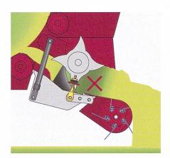
Der «Hydroflex»-Boden kann dank zwei Federelementen nachgeben und so Verstopfungen verhindern.
