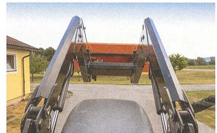
Durch die Integration der Parallelführung in die Ladeschwinge weitet sich das Sichtfeld des Fahrers wesentlich.
