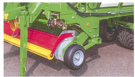
Ein Pendel-Pick-up garantiert unter allen Bedingungen schonende und saubere Futteraufnahme.
