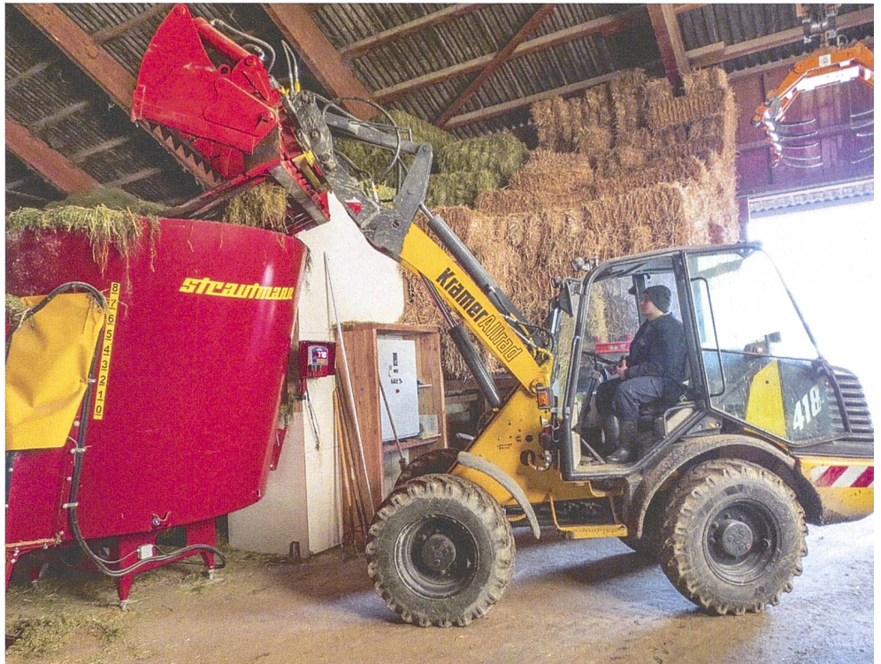
Der Radlader mit dem «GDS»-System wurde hauptsächlich für die Befüllung der Mischanlage und für den Güterumschlag genutzt. Die schwere Silageschneidezange verursachte grosse Belastungen am Kuppelsystem.
