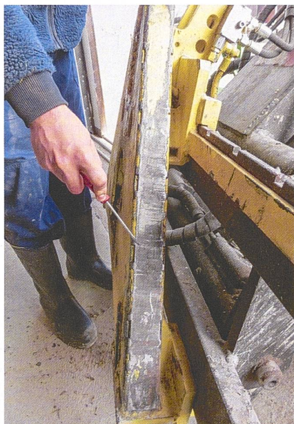
Eine Abnutzung an den Kuppelteilen und der Verriegelung ist nach über 5000 Kuppelvorgängen kaum feststellbar.
