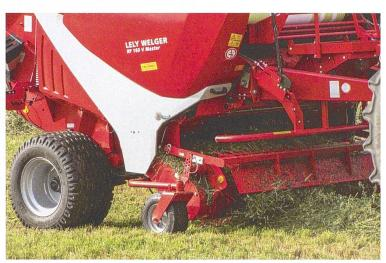
Der ungesteuerte Pick-up ist sowohl mit einem Blech als auch mit einem Rollenniederhalter erhältlich.
