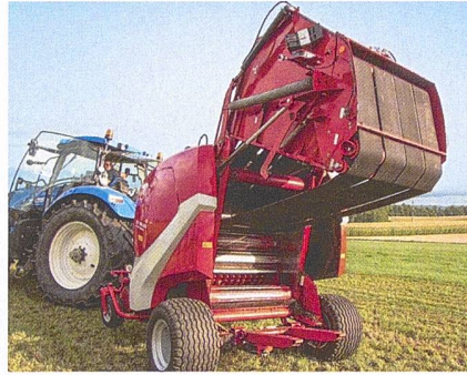
Der Verriegelungsmechanismus der Heckklappe ermöglicht einen schnellen Start nach dem Ballenauswurf.
