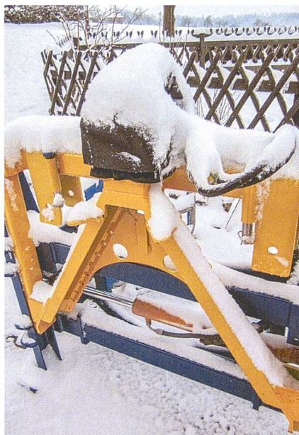
Die Neopren-Haube über den Kuppelkopf hat sich bewährt, Nässe und Kälte haben auch bei -10^{\circ}\text{C} keine Chance.
