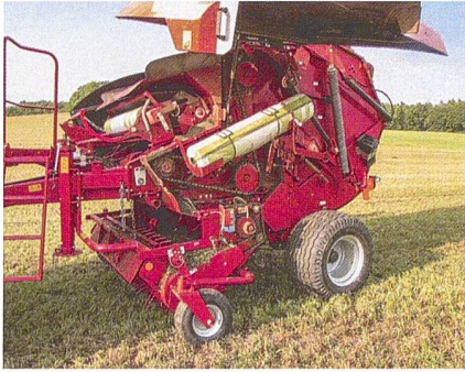
Die mitgeführte Netzrolle kann dank dem «Easy Load Net System» mit geringer Anstrengung in Arbeitsposition gebracht werden.
