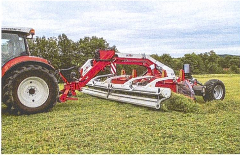
Zieht man die beiden Einheiten zusammen, entsteht ein Seitenschwader.
