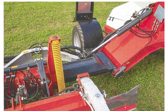
Die Schwadereinheiten sind am Ausleger um je einen Meter verschiebbar und werden mit mechanischen Federn entlastet.
