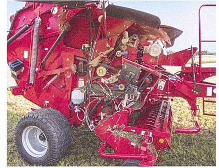
Für die Wartung sind die Komponenten wie die Elektronik dank sich weit öffnenden Verschaltungen gut zugänglich.
