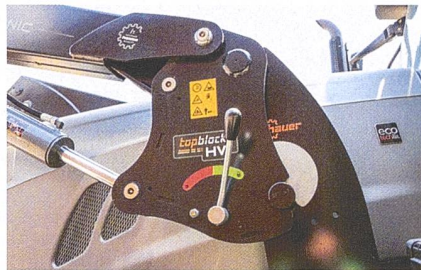
Die neue Konsole «Top Block HV» verriegelt beim Einfahren automatisch. Ein Haken (im Bild silbern) umschliesst den unteren Bolzen.
