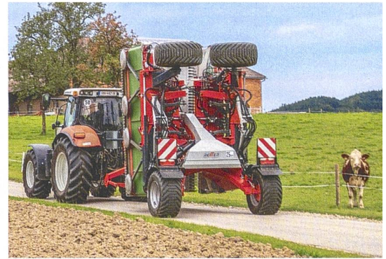
Die Breite des «Respiro R9» liegt für den Strassentransport bei 2,9m.
