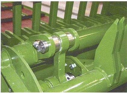
Das lenkergesteuerte Förderaggregat zeichnet sich durch grosse Laufruhe und Robustheit aus.
