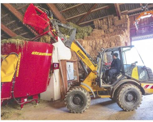
Der Radlader mit dem «GDS»-System wurde hauptsächlich für die Befüllung der Mischanlage und für den Güterumschlag genutzt. Die schwere Silageschneidezange verursachte grosse Belastungen am Kuppelsystem.
