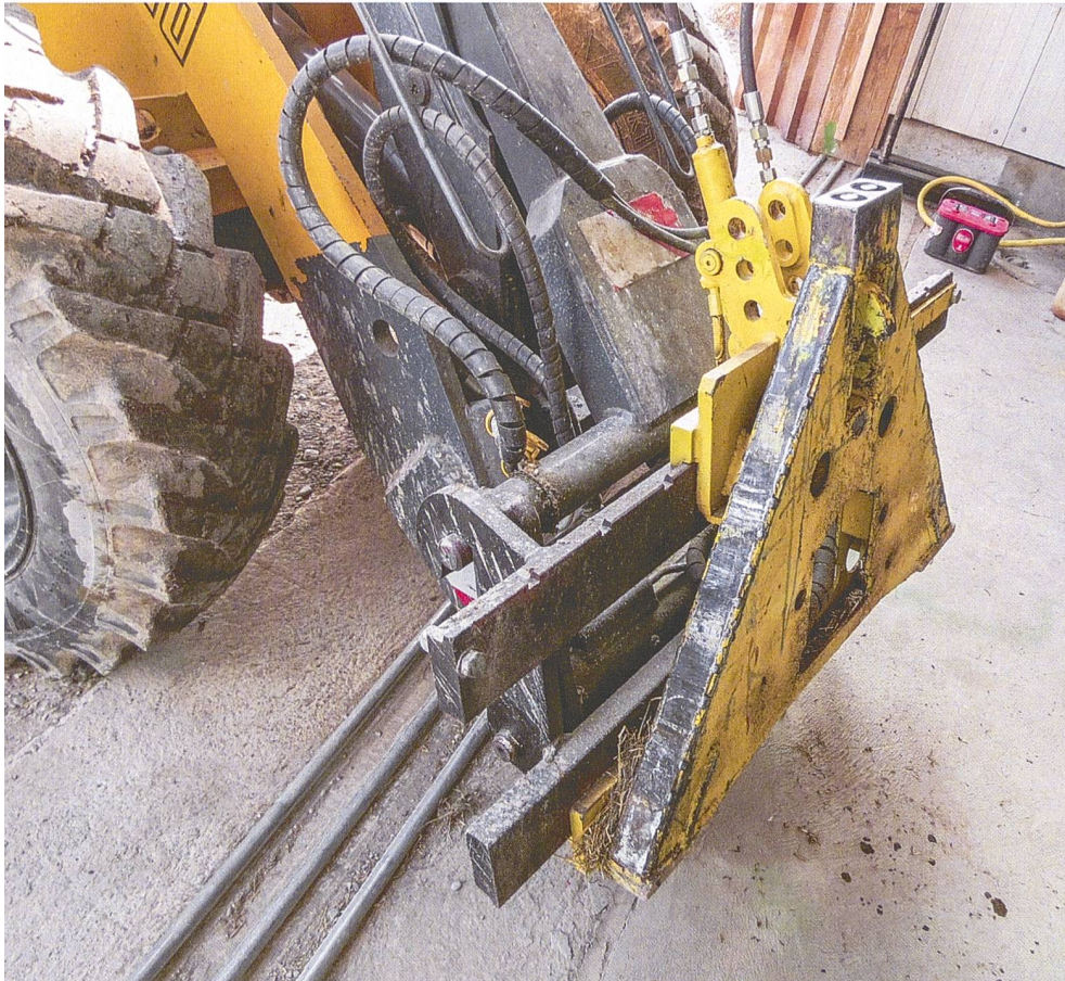
Das Modul am Radlader wird von der Seite auf den Palettengabelgrundträger aufgeschoben und mit einer Schraube fixiert. Der Schwerpunkt verlagert sich je nach Gerät rund 10 cm nach vorne. Bilder: M. Abderhalden
