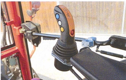
Der optionale, elektroproportionale Steuerhebel «ELC-ergo» bietet auf Wunsch einige Komfortfunktionen.
