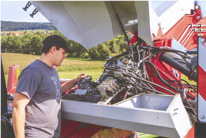
Blick auf die komplexe Bordhydraulik. Der Öltank ist im Rahmen untergebracht.
