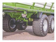
Das Tandemfahrwerk mit Lenkachse garantiert bestmögliche Bodenschonung und ist ringzügig.
