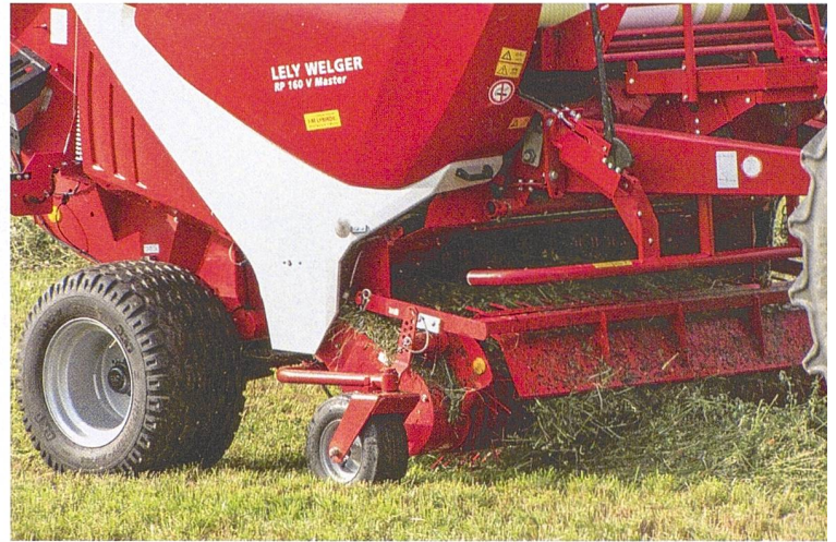
Der ungesteuerte Pick-up ist sowohl mit einem Blech als auch mit einem Rollenniederhalter erhältlich.
