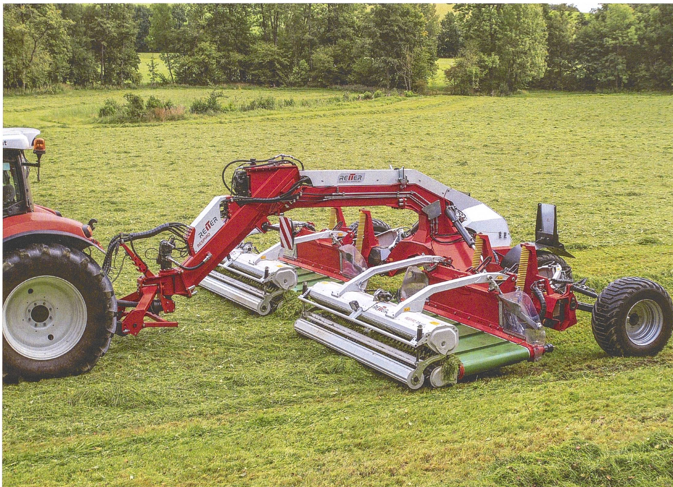
Nun gibt es das Bandschwaderkonzept «Respiro» in gezogener Heckversion mit maximal 9m Arbeitsbreite. Bilder: J. Paar
