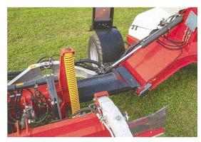
Die Schwadereinheiten sind am Ausleger um je einen Meter verschiebbar und werden mit mechanischen Federn entlastet.
